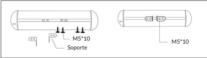
5. Utilice la perilla de bloqueo para fijar el radiador en el tubo como se indica en la ilustración.
