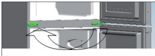
9. Posizionare la porta superiore sulla sospensione centrale e poi collegare la sospensione superiore. Infine, attaccare i tappi a vite e sostituire i coperchi. Bilanciare le piccole irregolarità sul pavimento con i piedini regolabili.
