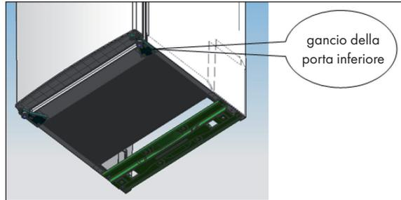
6. Rimuovere la cerniera della porta sul lato destro. Installare la cerniera della porta sul lato sinistro.
