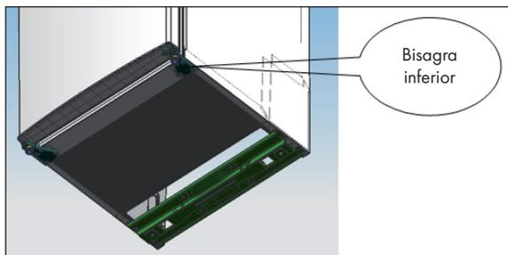
6. Retire el tope de la puerta de la parte derecha. Instale el tope en la parte izquierda.
