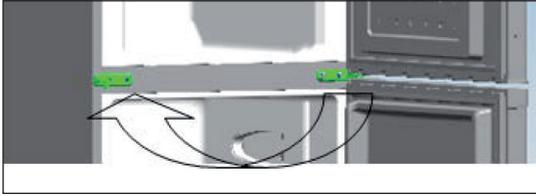
9. Coloque la puerta superior sobre la bisagra intermedia y fije a continuación la bisagra superior. Por último, coloque las tapas de los tornillos y las cubiertas decorativas. Salve las diferencias del terreno con ayuda de las patas ajustables.
