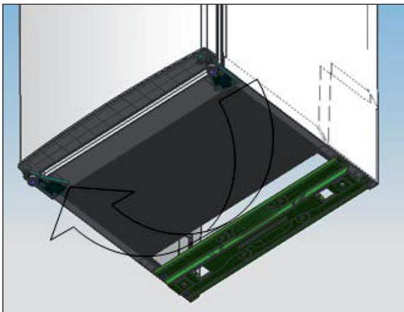
8. Coloque la puerta inferior sobre la bisagra inferior. Fije a continuación la bisagra central en el lado opuesto.
