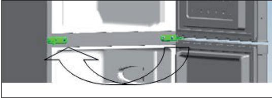
9. Setzen Sie die obere Tür auf die mittlere Aufhängung und befestigen Sie dann die obere Aufhängung. Befestigen Sie zum Schluss die Schraubenkappen und setzen Sie die Abdeckungen wieder auf. Gleichen Sie kleine Unebenheiten im Boden mit den verstellbaren Füßen aus.
