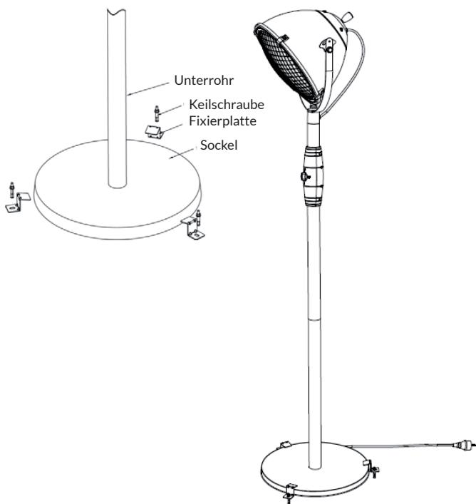
Befestigen Sie die Heizung auf dem Sockel. Bohren Sie drei Löcher in den Sockel und befestigen Sie den Heizkörper mit drei Keilschrauben am Boden. Ziehen Sie die Schrauben mit einem Schraubenschlüssel fest.
