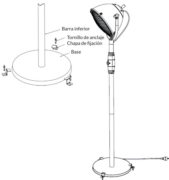
Fije la estufa al suelo. Perfore 3 orificios en el suelo y fije la estufa al suelo con 3 tornillos de anclaje. Atornille los tornillos con una llave de tuercas.
