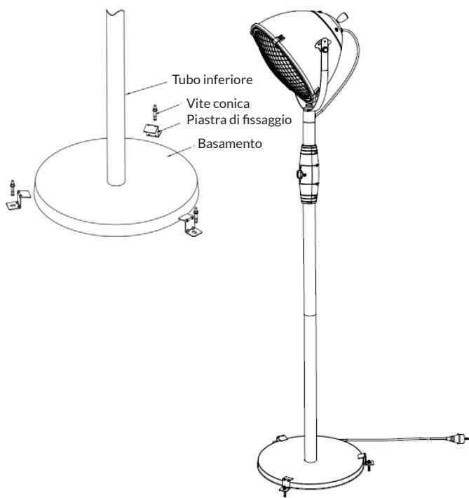
Fissare il radiatore al basamento. Realizzare tre fori sul basamento e fissare il radiatore al pavimento con le tre viti coniche. Stringere le viti saldamente.
