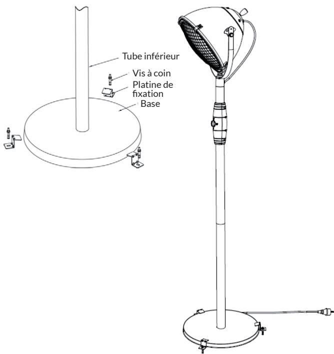
Fixez le radiateur à la base. Percez trois trous dans la base et fixez le radiateur sur le fond avec trois vis à coin. Serrez les vis avec une clé.
