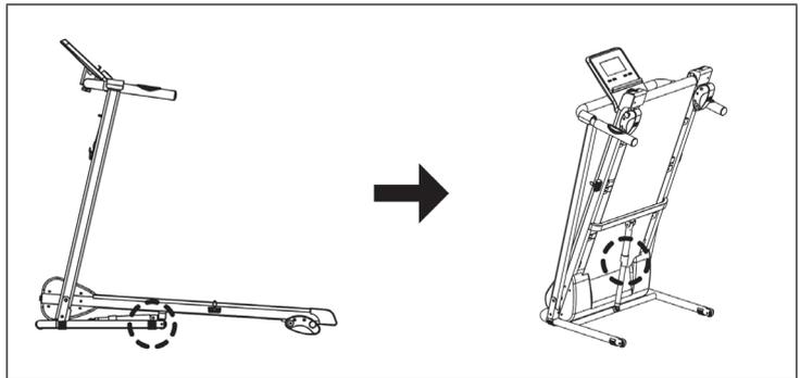
Hef na gebruik de veiligheidsvergrendeling op het onderste frame op. Klap de loopband in door de veiligheidsvergrendeling uit de linker standaard te trekken en deze los te laten om de loopband in een rechtopstaande positie te vergrendelen. Om te voorkomen dat u de veiligheidsgrendel verliest schroeft u deze in rechtopstaande positie aan het onderste en bovenste frame.
