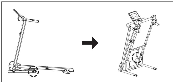
Dopo l'utilizzo, aprire il blocco di sicurezza sul telaio inferiore. Piegare il tapis roulant tirando fuori il blocco di sicurezza dal montante sinistro e lasciandolo andare per bloccare il tapis roulant in posizione verticale. Per non perdere il blocco di sicurezza, avvitarlo in posizione verticale al telaio inferiore e superiore.
