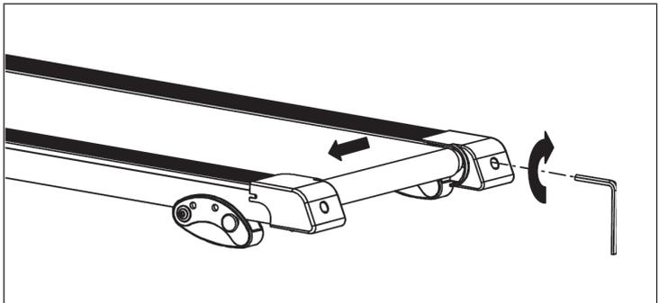
Wanneer de loopband naar rechts afwijkt, draait u de rechter instelschroef een kwart slag met de klok mee. De loopband begint zichzelf dan te corrigeren. Draai de instelschroeven net zolang totdat de loopband goed gecentreerd is.
