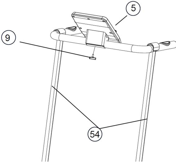
A: Draai het computerdisplay (5) naar boven of beneden om het gat voor de inbusschroef uit te lijnen.
