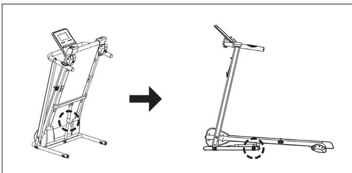
Lösen Sie die Sicherheitsverriegelung am unteren Rahmen, lösen Sie die ausziehbare Sicherheitsverriegelung und senken Sie den unteren Rahmen auf den Boden ab. Schrauben Sie die Sicherheitsverriegelung an den unteren Rahmen, um den oberen Rahmen in aufrechter Position zu verriegeln.
