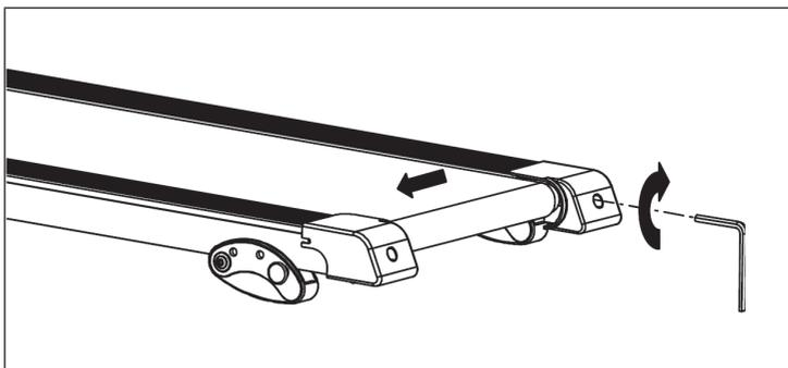
Se il nastro si sposta verso destra, ruotare in senso orario di  $\frac{1}{4}$  di giro la vite destra. Il nastro dovrebbe iniziare a correggersi da solo. Girare le viti di regolazione fino a quando il nastro è centrato.
