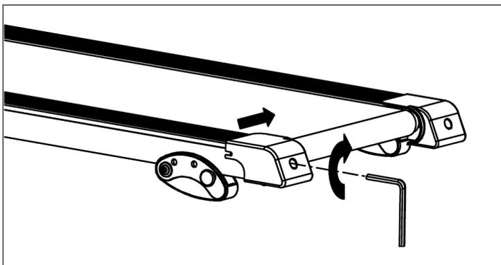
Cuando la cinta se mueva hacia la izquierda, gire el tornillo de ajuste izquierdo 1/4 de vuelta en el sentido de las agujas del reloj. La cinta debe empezar a corregirse a sí misma.
