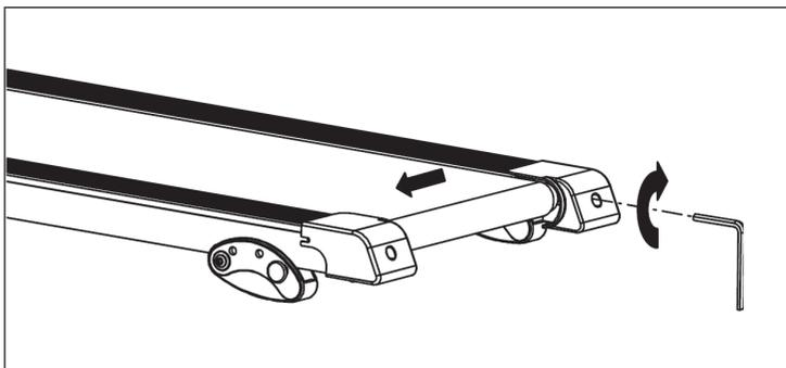
Wenn sich das Laufband nach rechts verschiebt, dann drehen Sie die rechte Einstellschraube 1/4 Umdrehung im Uhrzeigersinn. Das Laufband sollte beginnen, sich selbst zu korrigieren. Drehen Sie die Einstellschrauben so lange weiter, bis das Laufband richtig zentriert ist.
