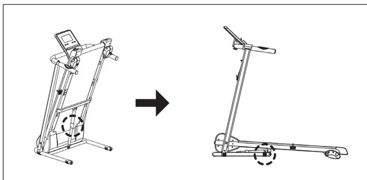
Suelte el bloqueo de seguridad del marco inferior, suelte el bloqueo de seguridad extraíble y baje el marco inferior hasta el suelo. Atornille el cierre de seguridad al marco inferior para bloquear el marco superior en la posición vertical.
