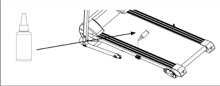
Levante un lado de la cinta. Ponga un poco de lubricante debajo de la mitad de la cinta en la parte superior de la plataforma de correr. Encienda la unidad y póngala en marcha a baja velocidad durante 3-5 minutos para asegurarse de que el lubricante esté distribuido uniformemente.
