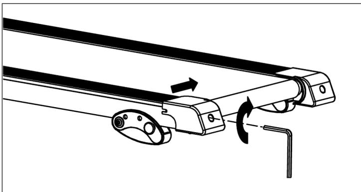
Wenn sich das Laufband nach links verschiebt, drehen Sie die linke Einstellschraube 1/4 Umdrehung im Uhrzeigersinn. Das Laufband sollte dann beginnen, sich selbst zu korrigieren.
