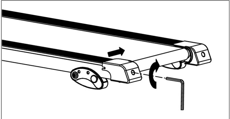
Wanneer de loopband naar links afwijkt, draait u de linker instelschroef een kwart slag met de klok mee. De loopband begint zichzelf dan te corrigeren.
