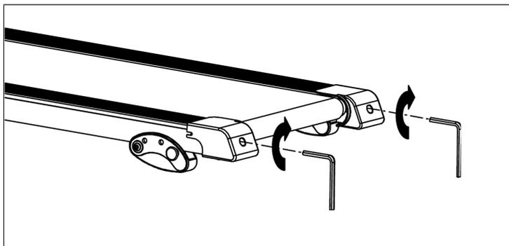
Se il nastro si sposta durante l'utilizzo, spegnere il tapis roulant e staccare la spina. Girare con la chiave a brugola da 6 mm sia la vite destra che sinistra per  $\frac{1}{4}$  di giro in senso orario. Accendere il dispositivo e far partire il tapis roulant a una velocità di 8-10 km/h. Correre sul tapis roulant per verificare se si sposta ancora. Ripetere la procedura fino a quando il nastro non si sposta più.
