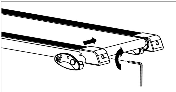
Se il nastro si sposta verso sinistra, ruotare in senso orario di  $\frac{1}{4}$  di giro la vite sinistra. Il nastro dovrebbe iniziare a correggersi da solo.
