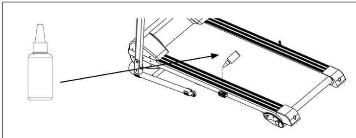
Sollevare un lato del tapis roulant. Mettere un po' di lubrificante sotto al centro del tapis roulant sul lato superiore del deck. Accendere il dispositivo e lasciarlo funzionare a bassa velocità per 3-5 minuti, in modo che il lubrificante si distribuisca in modo omogeneo.
