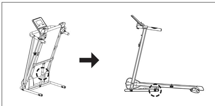
Aprire il blocco di sicurezza sul telaio inferiore, sbloccare il blocco di sicurezza e abbassare il telaio sul pavimento. Avvitare il blocco di sicurezza al telaio inferiore, in modo da bloccare il telaio superiore in posizione verticale.
