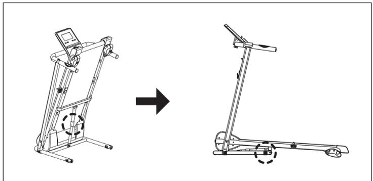
Haal de veiligheidsvergrendeling uit het onderste frame, neem de uittrekbare veiligheidsvergrendeling en laat het onderste frame naar de vloer zakken. Schroef de veiligheidsvergrendeling in het onderste frame om het bovenste deel van het frame in een rechtopstaande positie te vergrendelen.
