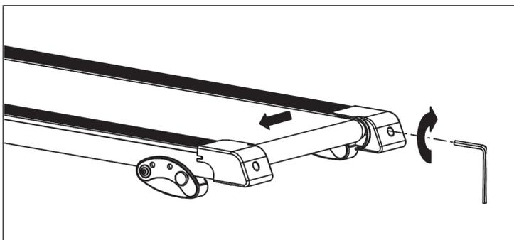
Cuando la cinta se mueva hacia la derecha, gire el tornillo de ajuste derecho 1/4 de vuelta en el sentido de las agujas del reloj. La cinta debe empezar a corregirse a sí misma. Continúe girando los tornillos de ajuste hasta que la cinta esté correctamente centrada.
