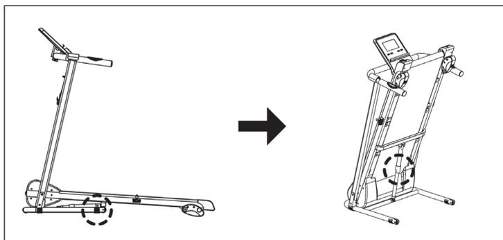
Después del uso, suelte el bloqueo de seguridad del marco inferior. Doble la cinta tirando y soltando del pestillo de seguridad desde el soporte izquierdo para bloquear la cinta en una posición vertical. Para no perder el bloqueo de seguridad, atornille el bloqueo de seguridad en posición vertical al marco inferior y superior.
