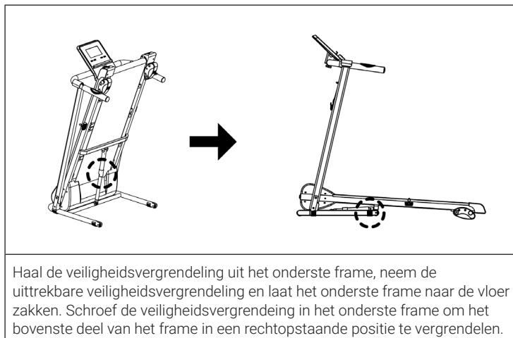
Haal de veiligheidsvergrendeling uit het onderste frame, neem de uittrekbare veiligheidsvergrendeling en laat het onderste frame naar de vloer zakken. Schroef de veiligheidsvergrendeling in het onderste frame om het bovenste deel van het frame in een rechtopstaande positie te vergrendelen.
