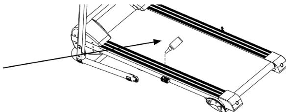
Eine Seite des Laufbandes anheben. Geben Sie etwas Schmiermittel unter die Mitte des Laufbandes auf die Oberseite des Laufdecks. Schalten Sie das Gerät ein und lassen Sie es für 3 – 5 Minuten bei niedriger Geschwindigkeit laufen, damit das Schmiermittel sich gleichmäßig verteilt.
