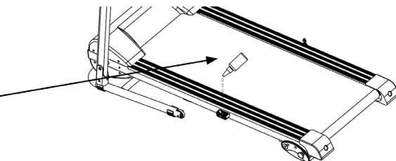
Sollevarе un lato del tapis roulant. Mettere un po' di lubrificante sotto al centro del tapis roulant sul lato superiore del deck. Accendere il dispositivo e lasciarlo funzionare a bassa velocità per 3-5 minuti, in modo che il lubrificante si distribuisca in modo omogeneo.
