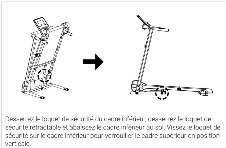
Desserrez le loquet de sécurité du cadre inférieur, desserrez le loquet de sécurité rétractable et abaissez le cadre inférieur au sol. Vissez le loquet de sécurité sur le cadre inférieur pour verrouiller le cadre supérieur en position verticale.
