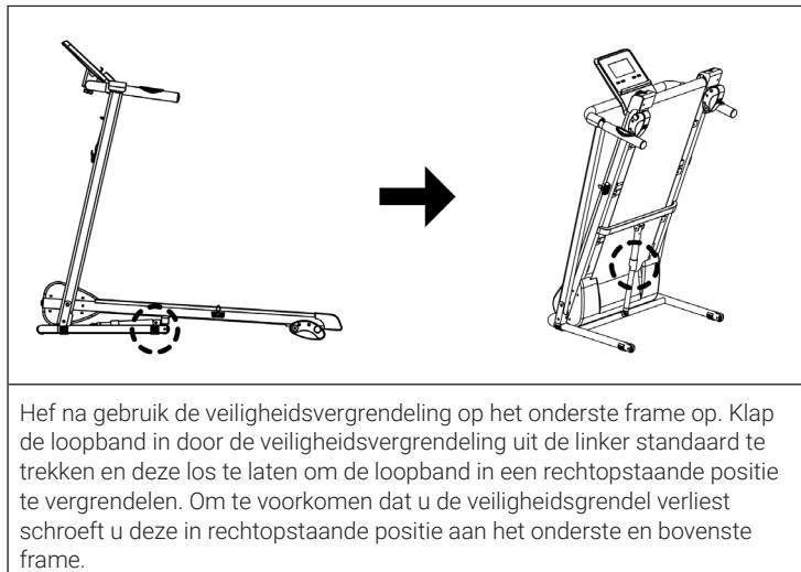
Hef na gebruik de veiligheidsvergrendeling op het onderste frame op. Klap de loopband in door de veiligheidsvergrendeling uit de linker standaard te trekken en deze los te laten om de loopband in een rechtopstaande positie te vergrendelen. Om te voorkomen dat u de veiligheidsgrendel verliest schroeft u deze in rechtopstaande positie aan het onderste en bovenste frame.
