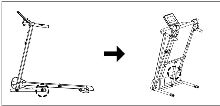
Lösen Sie nach dem Gebrauch die Sicherheitsverriegelung am unteren Rahmen auf. Klappen Sie das Laufband, indem Sie die Sicherheitsverriegelung aus dem linken Ständer herausziehen und loslassen, um das Laufband in aufrechter Position zu arretieren. Um den Sicherheitsverschluss nicht zu verlieren, schrauben Sie den Sicherheitsverschluss in aufrechter Position an den unteren und oberen Rahmen.
