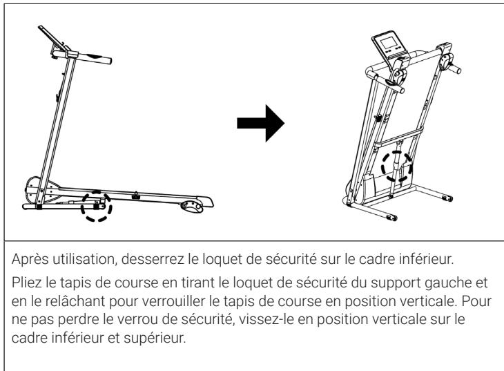
Après utilisation, desserrez le loquet de sécurité sur le cadre inférieur.
