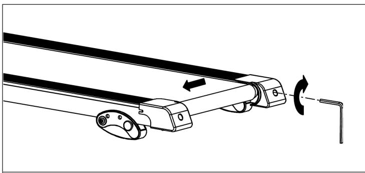
Si le tapis roulant se déplace vers la droite, tournez la vis de réglage droite de 1/4 de tour dans le sens des aiguilles d'une montre. Le tapis roulant devrait commencer à se corriger. Continuer à tourner les vis de réglage jusqu'à ce que le tapis roulant soit correctement centré.
