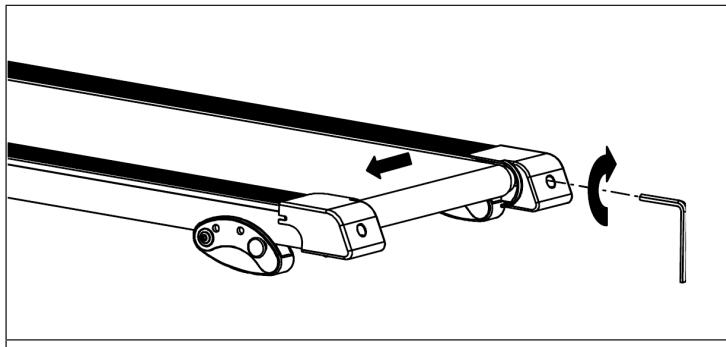
Cuando la cinta se mueve hacia la derecha, gire el tornillo de ajuste derecho 1/4 de vuelta en el sentido de las agujas del reloj. La cinta debe empezar a corregirse a sí misma. Continúe girando los tornillos de ajuste hasta que la cinta esté correctamente centrada.
