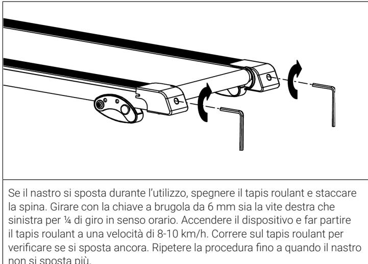
Se il nastro si sposta durante l'utilizzo, spegnere il tapis roulant e staccare la spina. Girare con la chiave a brugola da 6 mm sia la vite destra che sinistra per  $\frac{1}{4}$  di giro in senso orario. Accendere il dispositivo e far partire il tapis roulant a una velocità di 8-10 km/h. Correre sul tapis roulant per verificare se si sposta ancora. Ripetere la procedura fino a quando il nastro non si sposta più.
