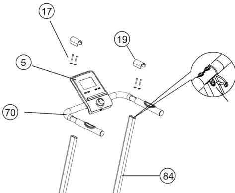
A: Quite los cuatro tornillos de cabeza cilíndrica (17) que se encuentran en el extremo del tubo vertical izquierdo y el derecho.
