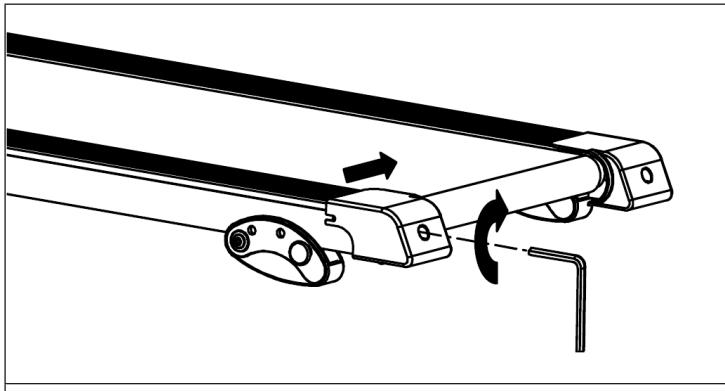
Se il nastro si sposta verso sinistra, ruotare in senso orario di  $\frac{1}{4}$  di giro la vite sinistra. Il nastro dovrebbe iniziare a correggersi da solo.
