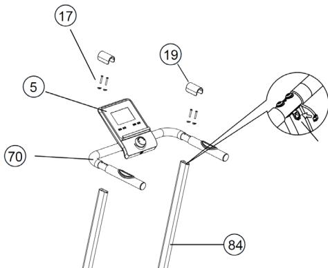
A: Retirez les quatre vis à six pans creux (17) à l'extrémité des montants gauche et droit.
