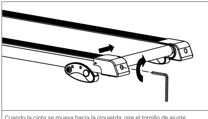
Cuando la cinta se mueva hacia la izquierda, gire el tornillo de ajuste izquierdo 1/4 de vuelta en el sentido de las agujas del reloj. La cinta debe empezar a corregirse a sí misma.
