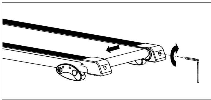
Wanneer de loopband naar rechts afwijkt, draait u de rechter instelschroef een kwart slag met de klok mee. De loopband begint zichzelf dan te corrigeren. Draai de instelschroeven net zolang totdat de loopband goed gecentreerd is.
