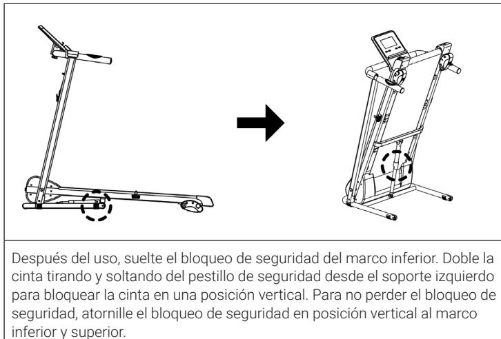
Después del uso, suelte el bloqueo de seguridad del marco inferior. Doble la cinta tirando y soltando del pestillo de seguridad desde el soporte izquierdo para bloquear la cinta en una posición vertical. Para no perder el bloqueo de seguridad, atornille el bloqueo de seguridad en posición vertical al marco inferior y superior.
