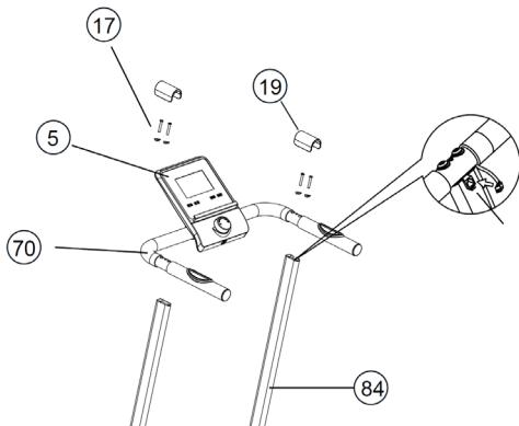
A: Entfernen Sie die vier Inbusschrauben (17) am Ende des linken Standrohrs und des rechten Standrohrs.
