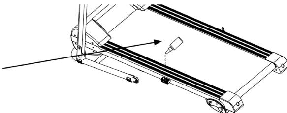
Til een kant van de loopband op en doe wat smeermiddel onder het midden van het loopdek. Zet het apparaat aan en laat het gedurende 3-5 minuten op geringe snelheid lopen zodat het smeermiddel zich gelijkmatig verdeelt.
