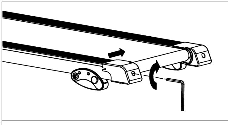
Wenn sich das Laufband nach links verschiebt, drehen Sie die linke Einstellschraube 1/4 Umdrehung im Uhrzeigersinn. Das Laufband sollte dann beginnen, sich selbst zu korrigieren.
