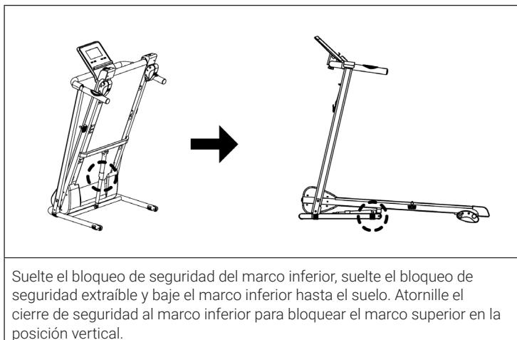
Suelte el bloqueo de seguridad del marco inferior, suelte el bloqueo de seguridad extraíble y baje el marco inferior hasta el suelo. Atornille el cierre de seguridad al marco inferior para bloquear el marco superior en la posición vertical.
