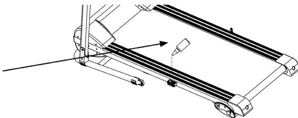
Soulevez un côté du tapis roulant. Mettez un peu de lubrifiant sous le tapis de course au-dessus de la plateforme de course. Allumez l'appareil et faites-le fonctionner pendant 3 à 5 minutes à basse vitesse pour répartir le lubrifiant uniformément.
