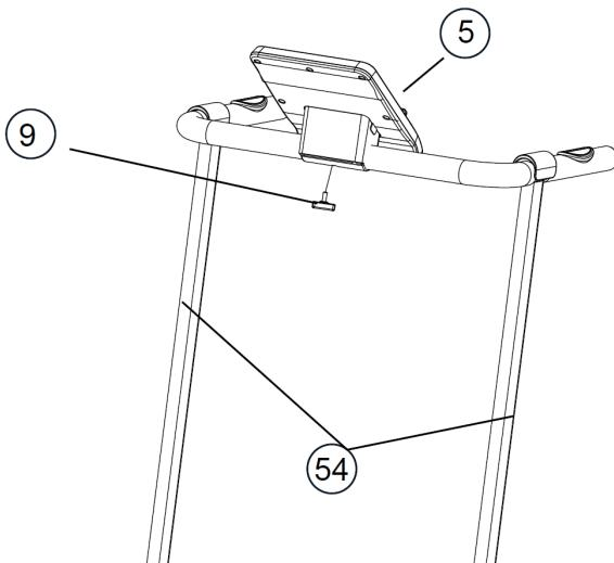
A: Drehen Sie das Computerdisplay (5) nach oben oder unten, um das Loch für die Inbusschraube auszurichten.
