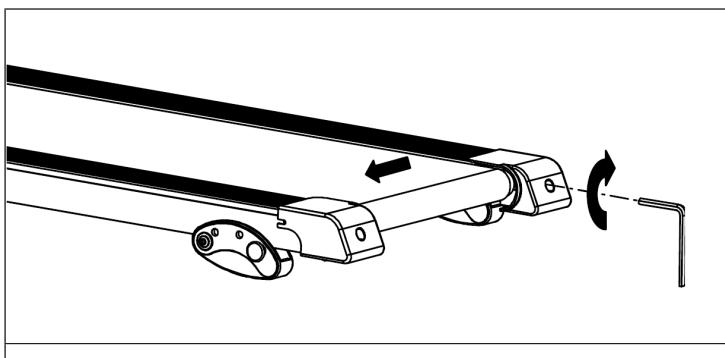
Se il nastro si sposta verso destra, ruotare in senso orario di  $\frac{1}{4}$  di giro la vite destra. Il nastro dovrebbe iniziare a correggersi da solo. Girare le viti di regolazione fino a quando il nastro è centrato.
