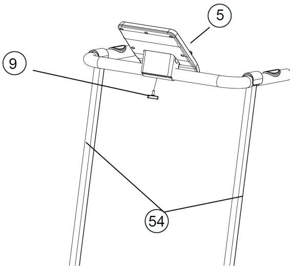
A: Gire la pantalla del ordenador (5) hacia arriba o hacia abajo para alinear el orificio para el tornillo Allen.
