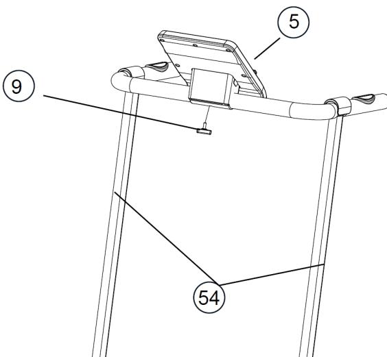
A: muovere il display del computer (5) in alto o in basso per mostrare il foro per la vite a brugola.
