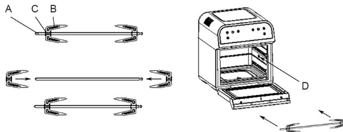
Faites glisser les fixateurs (B) sur la tige de la broche (A). Serrez les vis des fixateurs (C) afin que les fixateurs soient solidement fixés à la broche. Insérez la broche dans les rotateurs (D) de l'appareil. Elle ne peut rentrer dans les rotateurs que d'une certaine manière. Ne forcez pas lors de l'assemblage.
