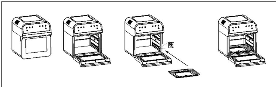
Abra la puerta con cuidado e introduzca la bandeja recogegotas en el aparato por los carriles laterales, tal como se muestra en la ilustración.
