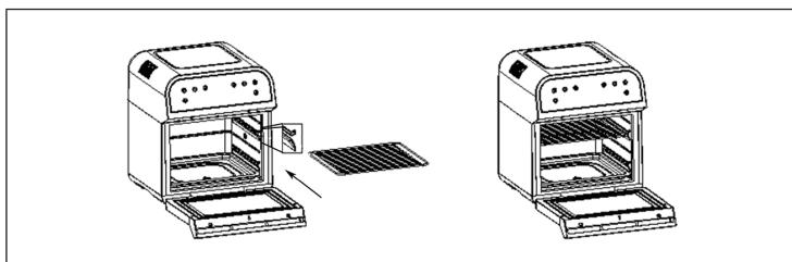
Öffnen Sie vorsichtig die Tür und schieben Sie das Tropfblech auf den Seitenschienen wie in der Abbildung gezeigt in das Gerät ein.
