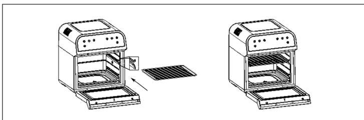
Ouvrez la porte avec précaution et glissez la lèchefrite dans l'appareil sur les rails latéraux comme indiqué sur l'image.
