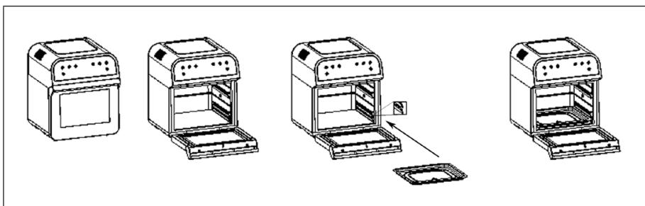
Öffnen Sie vorsichtig die Tür und schieben Sie das Tropfblech auf den Seitenschienen wie in der Abbildung gezeigt in das Gerät ein.
