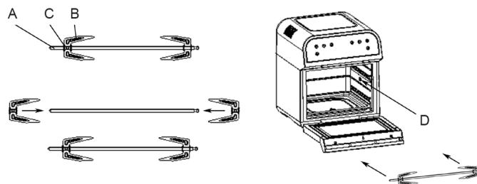
Schieben Sie die Fixateure (B) auf den Drehspießstab (A). Drehen Sie die Schrauben der Fixateure (C) fest, sodass die Fixateure fest am Drehspieß sitzen. Setzen Sie den Drehspieß in die Rotatoren (D) im Gerät ein. Er passt nur auf eine bestimmte Weise in die Rotatoren. Wenden Sie keine Gewalt an.
