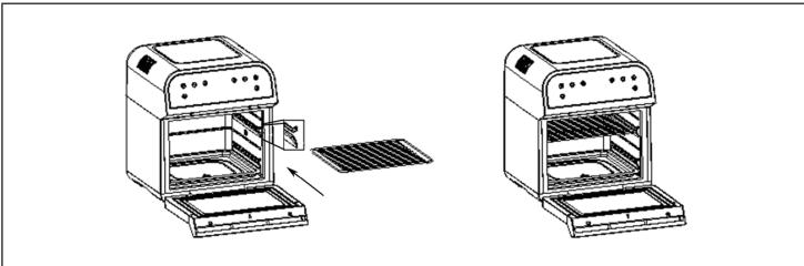
Abra la puerta con cuidado e introduzca la bandeja recogegotas en el aparato por los carriles laterales, tal como se muestra en la ilustración.
