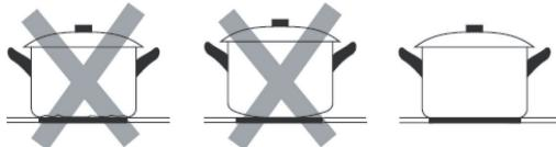
La batería de cocina que esté fabricada en los siguientes materiales no es adecuada: acero inoxidable puro, aluminio o cobre sin base magnética, cristal, madera, porcelana, cerámica y loza. No utilice batería de cocina que tenga cantos afilados o presente una parte inferior abombada.
