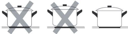
Les ustensiles de cuisine fabriqués à partir des matériaux suivants ne sont pas compatibles : acier inoxydable pur, aluminium ou cuivre sans fond magnétique, verre, bois, porcelaine, céramique et faïence. N'utilisez pas d'ustensiles de cuisine ayant des bords tranchants ou un fond arrondi.
