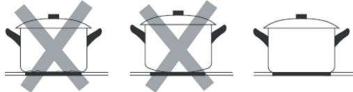
Kochgeschirr, welches aus den folgenden Materialien hergestellt wurde, ist nicht geeignet: reines Edelstahl, Aluminium oder Kupfer ohne magnetische Unterseite, Glas, Holz, Porzellan, Keramik und Töpfware. Verwenden Sie kein Kochgeschirr, welches scharfe Kanten oder eine abgerundete Unterseite aufweist.
