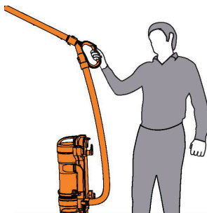
Important : lorsque vous utilisez le flexible et la tige télescopique, tenez l'appareil fermement en hauteur.
