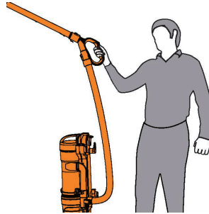
Wichtig: Halten Sie das Gerät bei der Verwendung des Schlauchs und des Teleskoprohrs in der Höhe fest.
