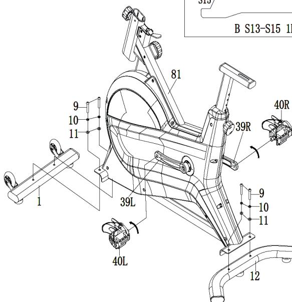
Fissare lo stabilizzatore anteriore (1) e posteriore (12) al telaio principale (81) con viti (9), rondelle elastiche (10) e rondelle (11). Stringere le viti con la chiave a brugola (94).
