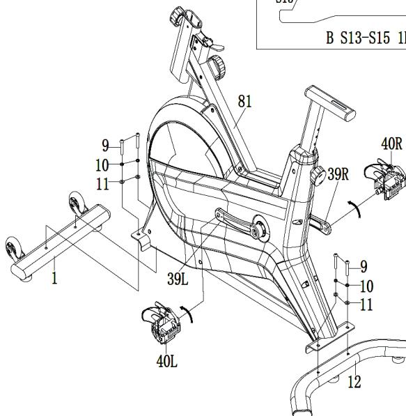
Befestigen Sie den vorderen (1) und hinteren Stabilisator (12) mit Schrauben (9), Federscheiben (10) und Unterlegscheiben (11) am Hauptrahmen (81). Ziehen Sie die Schrauben mit dem Inbusschlüssel (A) fest.
