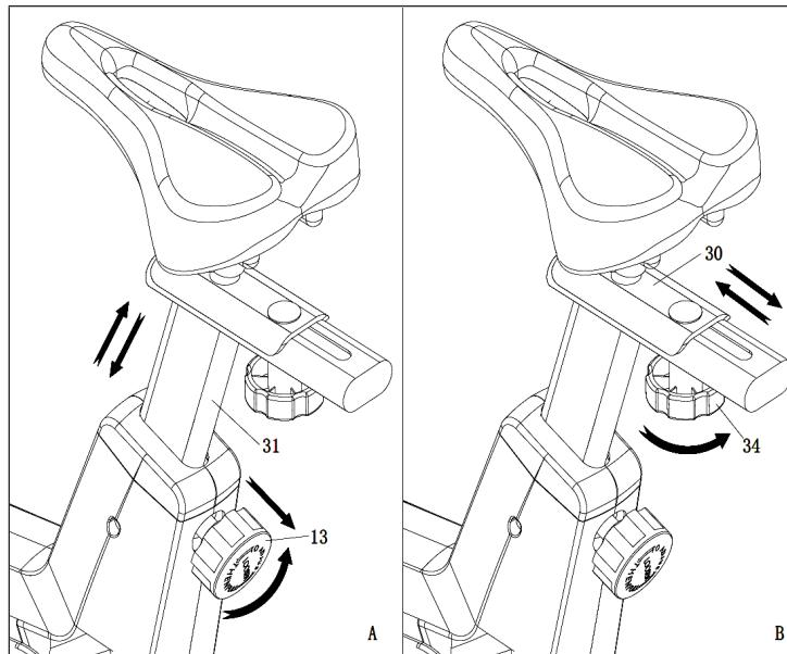
Um die Höhe der Sattelstütze (Nr. 31) einzustellen, lösen und ziehen Sie den Knopf (13) heraus und heben oder senken Sie den Sitz auf die gewünschte Höhe. Nach der Einstellung setzen Sie den Knopf (13) wieder ein und ziehen ihn fest, um den Sitz zu sichern (Abbildung A).
