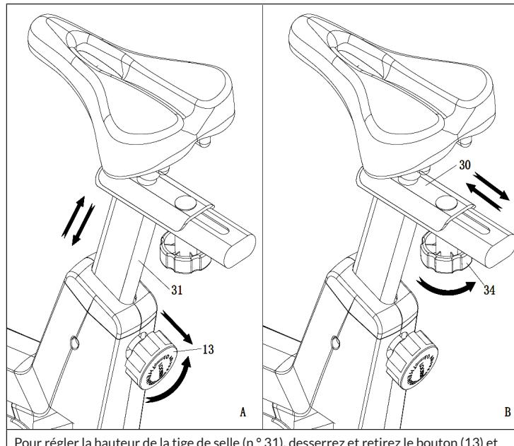
Pour régler la hauteur de la tige de selle (n ° 31), desserrez et retirez le bouton (13) et élévez ou abaissez le siège à la hauteur souhaitée. Après le réglage, réinsérez le bouton (13) et serrez-le pour fixer le siège (Figure A).
