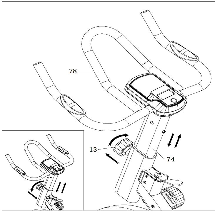
Pour régler la hauteur du guidon (78), desserrez et retirez le bouton (13), puis faites glisser le support du guidon (74) à la hauteur souhaitée. Une fois le réglage effectué, resserrez le bouton (13) pour fixer le support de guidon (74).
