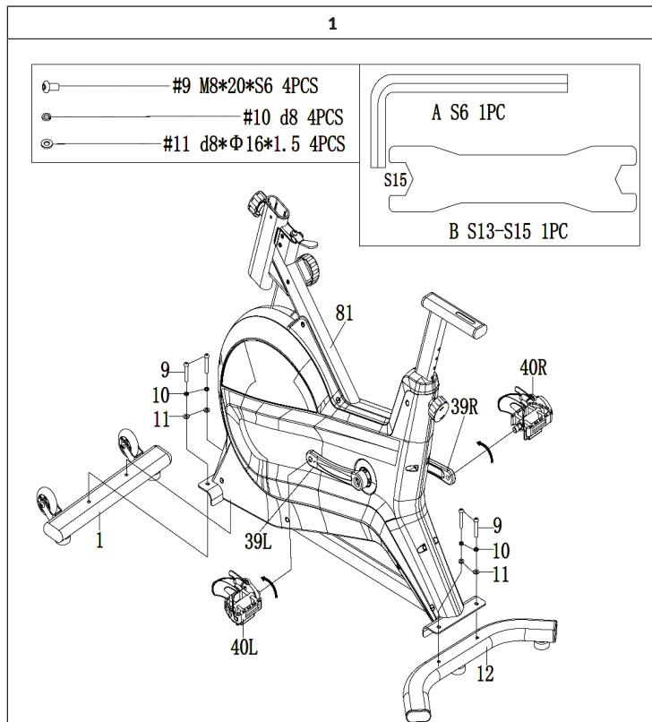
Fixez les stabilisateurs avant (1) et arrière (12) au cadre principal (81) à l'aide des vis (9), des rondelles à ressort (10) et des rondelles (11). Serrer les vis avec la clé Allen (94).
