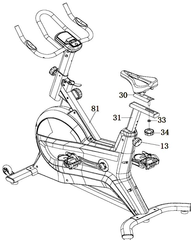
Fissare la guida della sella (30) sul supporto della sella (31). Stringerlo saldamente e fissarlo con la rondella (33) e la manopola (34).
