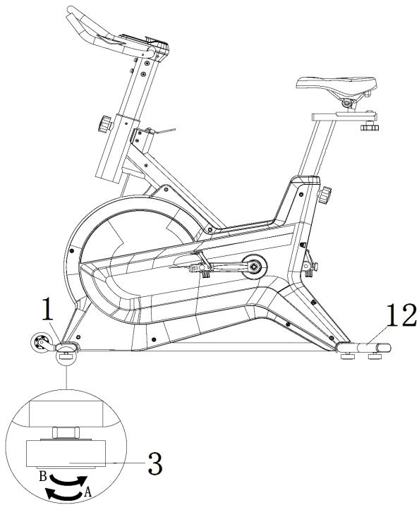
Para garantizar el buen funcionamiento del dispositivo, asegúrese de que la bicicleta sea estable. Si durante el uso nota que la bicicleta está desequilibrada, puede ajustar los pies (3) debajo del estabilizador delantero (1) y trasero (12).
