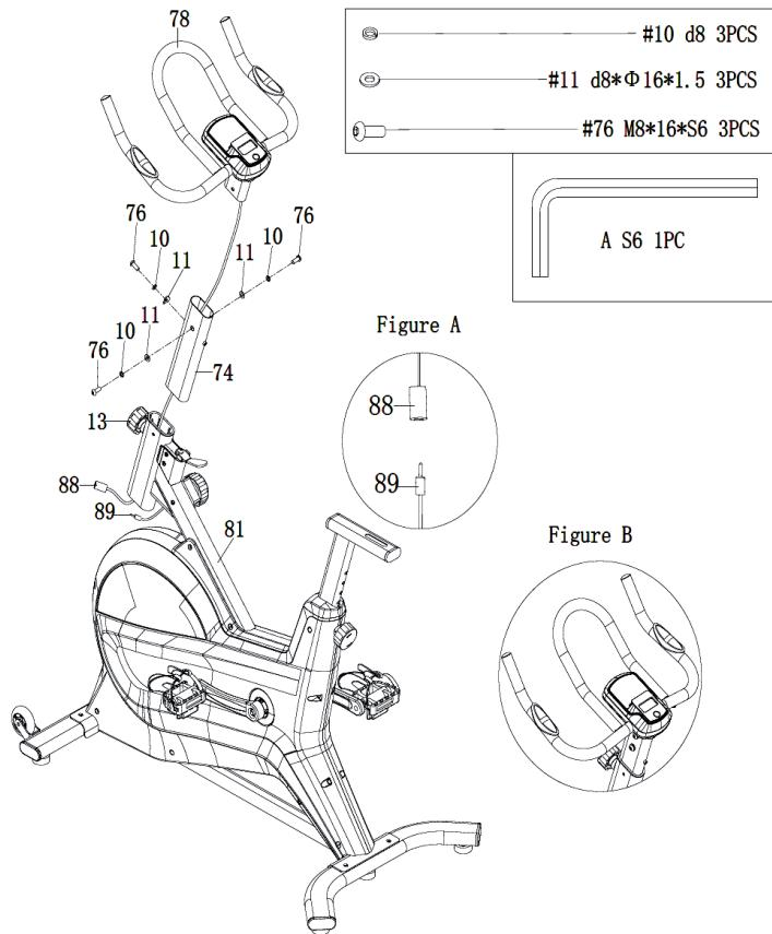
Inserte el cable (88) a través de la tija de sillín (74). A continuación, fije el manillar (78) al soporte del manillar (74) con tornillos (76), arandelas elásticas (10) y arandelas (11). Apriete los tornillos con la llave Allen (94).
