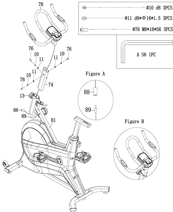
Far passare il cavo (88) attraverso il supporto della sella (74). Fissare quindi il manubrio (78) al supporto del manubrio (74) con viti (76), rondelle elastiche (10) e rondelle (11). Stringere le viti con la chiave a brugola (94).
