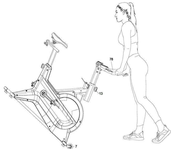
Avant de déplacer le vélo, assurez-vous que le guidon (78) est correctement verrouillé. Si le guidon (78) est desserré, resserrez le bouton (13). Placez-vous ensuite à l'avant du vélo de manière à vous placer devant le guidon (78). Tenez les deux côtés du guidon, placez un pied sur la base avant et inclinez le vélo vers vous jusqu'à ce que les roues de transport (7) touchent le sol. Ensuite, faites rouler l'appareil à l'emplacement souhaité.
