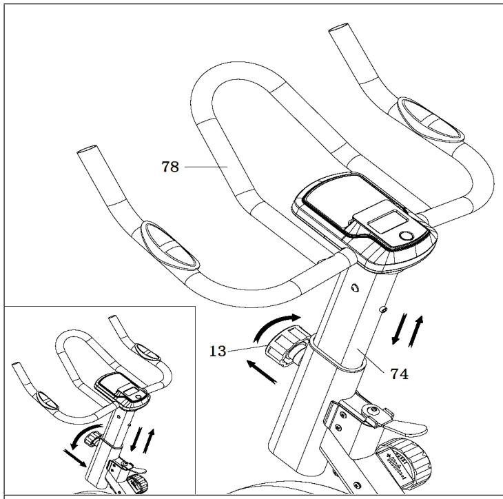
Para ajustar la altura del manillar (78), afloje y tire del pomo (13) y, a continuación, deslice el soporte del manillar (74) hasta la altura deseada. Después del ajuste, apriete el pomo (13) para fijar el soporte del manillar (74).
