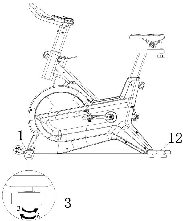
Per fare in modo che il dispositivo funzioni senza problemi, assicurarsi che sia posizionato stabilmente. Se si nota che il dispositivo non è bilanciato durante l'utilizzo, regolare i piedi (3) sotto agli stabilizzatori anteriore (1) e posteriore (12).
