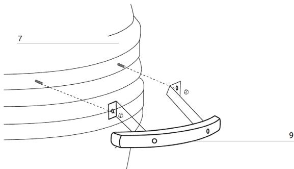
**9** Fixez la poignée (9) avec les écrous borgnes sur les vis préinstallées.
