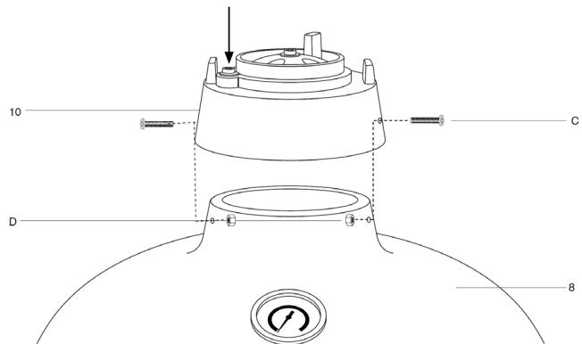
**10** Pour fixer la sortie d'air supérieure (10) au corps du barbecue (7), réglez-la et alignez-la sur les deux trous. Fixez-la avec 2 vis (C) et écrous (D). La vis de sortie d'air supérieure (voir flèche) doit être située du côté gauche lors de l'installation.
