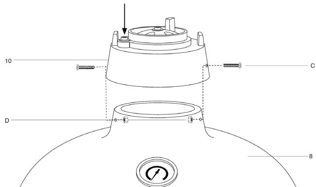
**10** Per montare il componente per il rilascio dell'aria (10) al corpo della griglia (7), poggiarlo sopra, orientandolo sui due fori. Fissare con 2 viti (C) e dadi (D). La vite superiore del componente di rilascio dell'aria si trova a sinistra nel montaggio.
