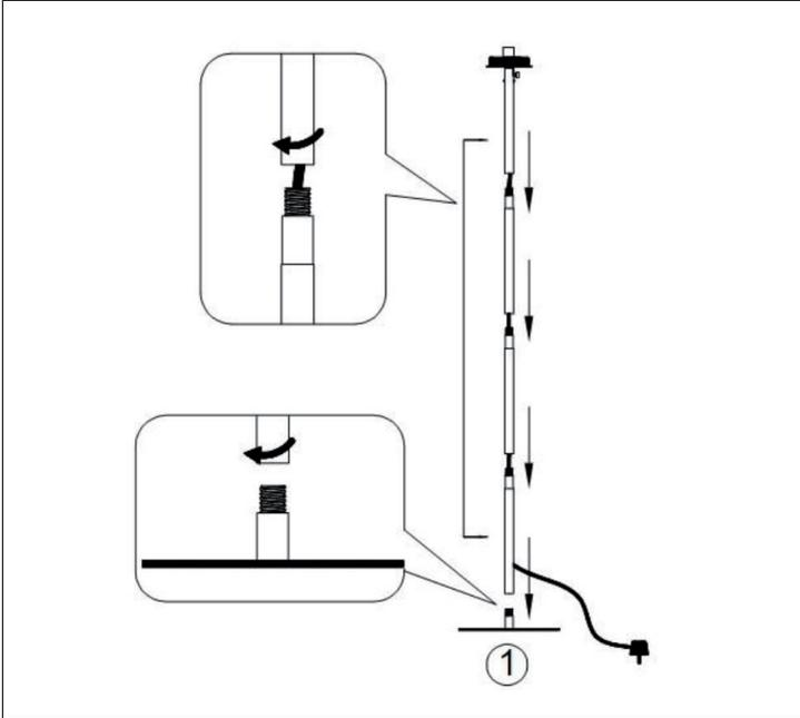
1. Placez le câble à travers les quatre segments. Connectez les quatre segments ensemble en les tournant dans le sens des aiguilles d'une montre et fixez les à la base de la lampe.
