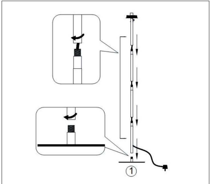
1. Ziehen Sie das Kabel durch die Segmente des Lampenstiels. Die Segmente im Uhrzeigersinn festdrehen und am Lampenfuß fixieren.
