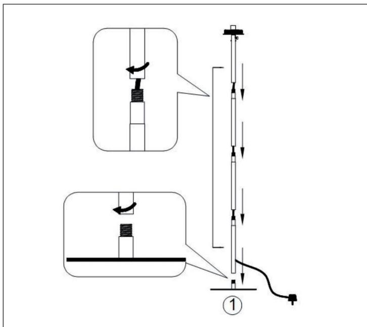
1. Introduzca el cable por las cuatro piezas. Conecte las piezas entre si con movimientos circulares siguiendo el sentido las agujas del reloj y fíjelas después a la base de la lámpara.
