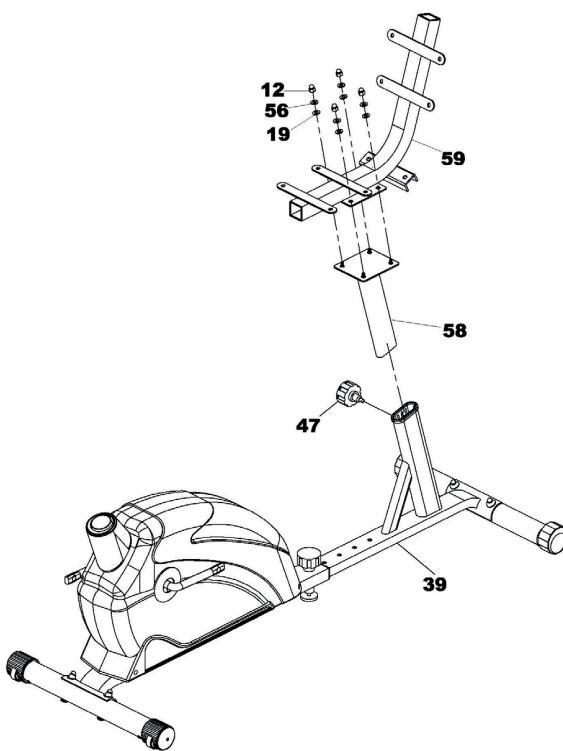
A) Setzen Sie die Sattelstütze (58) in den hinteren Hauptrahmen (39) ein und ziehen Sie sie mit dem Federknopf (47) an.
