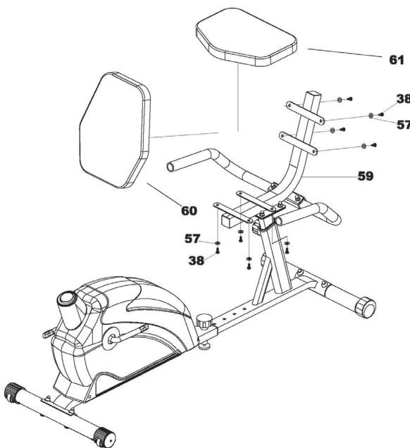
A) Fissare la seduta (61) al tubo dell'imbottitura dello schienale (59) con 4 rondelle (57) e 4 viti esagonali (38).
