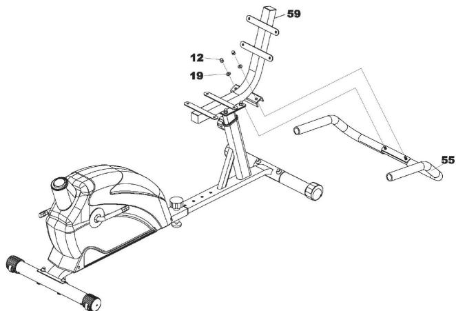
A) Fixez les poignées de siège (55) au tube du coussin de dossier (59) à l'aide de 2 rondelles (19) et 2 écrous borgnes (12).
