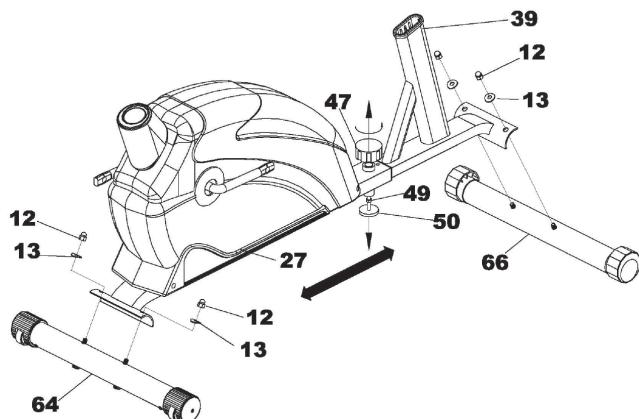
A) Befestigen Sie den vorderen Stabilisator (64) am vorderen Hauptrahmen (27) und sichern Sie ihn mit einer 2 Unterlegscheiben (13) und 2 Hutmuttern (12). Befestigen Sie den hinteren Stabilisator (66) auf die gleiche Weise.
