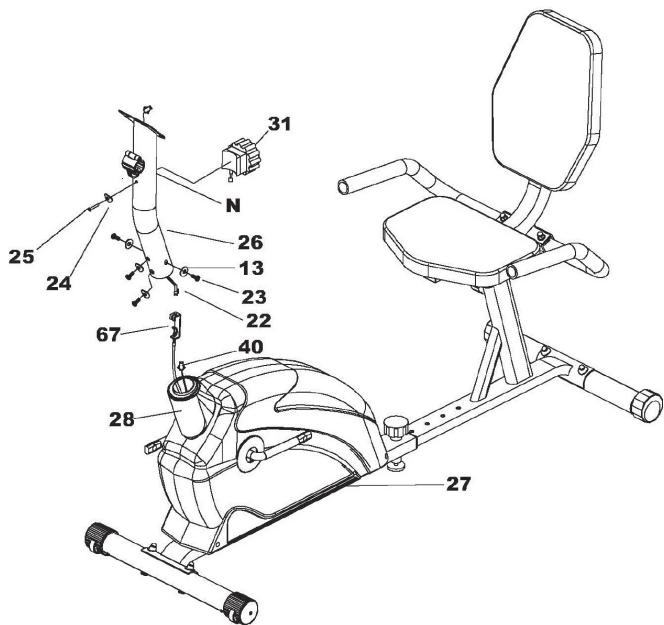
A) Prendere il palo anteriore (26) e collegare il cavo centrale del computer (22) con il cavo inferiore del computer (40). Far passare il cavo di tensionamento inferiore (67) attraverso il palo anteriore (26) e farlo uscire dal foro sul lato superiore. Collegare il cavo di tensionamento inferiore (67) con il cavo di tensionamento (31) in direzione della freccia. Fissare poi la manopola di tensionamento con 1 rondella (24) e 1 vite (25).
