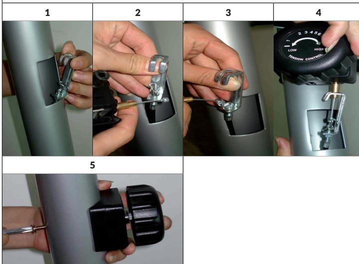
Bild 1: Ziehen Sie das Spannkabel aus dem vorderen Pfosten.
