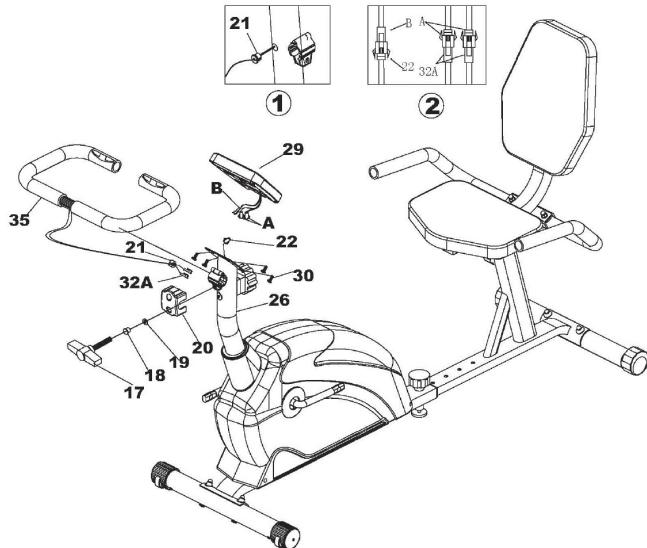
A) Fissare il manubrio (35) al palo anteriore (26) e fissare il manubrio e la sua copertura (20) con 1 rondella (19), un distanziatore (18) e la vite di regolazione (17). Far passare il cavo del battito cardiaco (32 A) attraverso il manicotto A (21) e tirarlo verso l'alto dal centro del palo anteriore (26).
