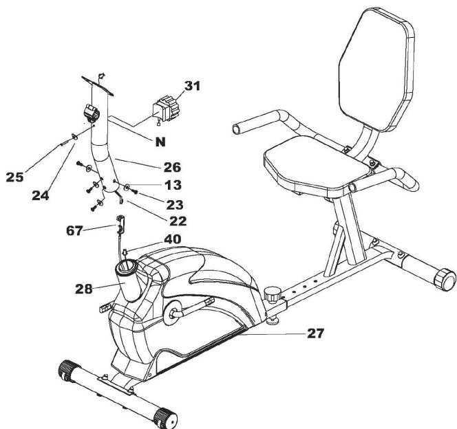
A) Prenez le montant avant (26) et reliez le câble d'ordinateur central (22) au câble inférieur de l'ordinateur (40). Tirez le câble de tension inférieur (67) à travers le montant avant (26) et faites-le sortir par le trou situé en haut. Reliez ensuite le câble de tension inférieur (67) au câble de tension (31) dans le sens de la flèche. Fixez ensuite le bouton de réglage de la tension avec 1 rondelle (24) et une vis (25).
