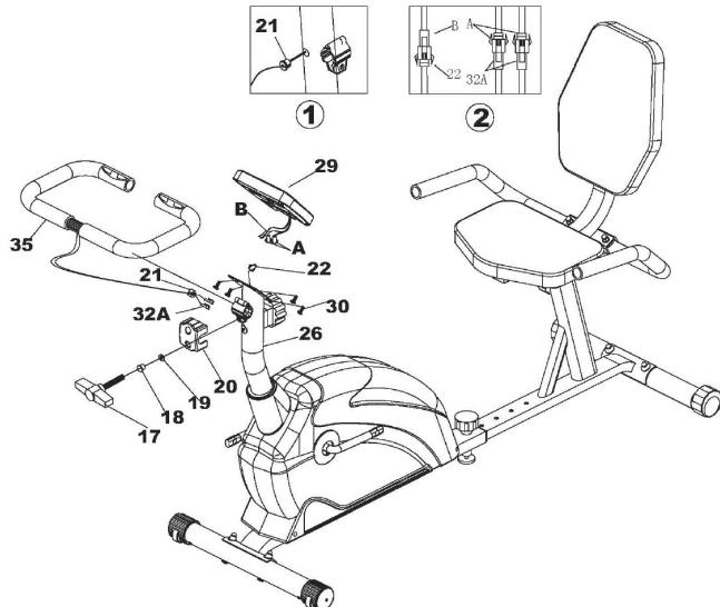
A) Fije el manillar (35) al poste delantero (26) y apriete el manillar y la cubierta del manillar (20) con 1 arandela (19), 1 separador (18) y el tornillo de ajuste (17). Pase el cable de impulso central (32A) por el cojinete A (21) y a continuación tire de él desde el medio del poste delantero (26) hacia arriba.
