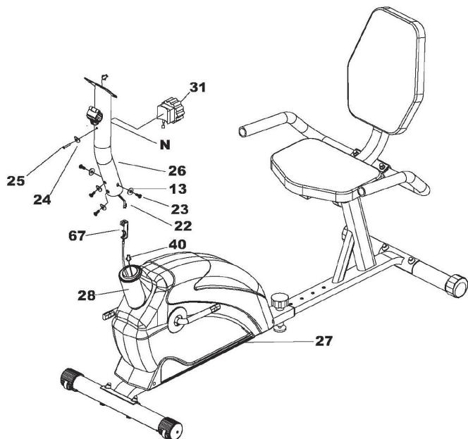
A) Coja el poste delantero (26) y conecte el cable central del ordenador (22) al cable inferior (40). Pase el cable tensor inferior (67) por el poste delantero (26) y sáquelo por el orificio de la parte superior. Una el cable tensor inferior (67) en el sentido de las flechas con el cable tensor (31). Fije a continuación el pin de tensión con 1 arandela (24) y un tornillo (25).
