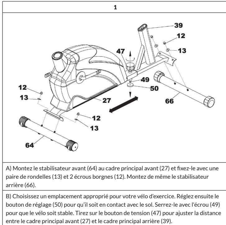
A) Montez le stabilisateur avant (64) au cadre principal avant (27) et fixez-le avec une paire de rondelles (13) et 2 écrous borgnes (12). Montez de même le stabilisateur arrière (66).
