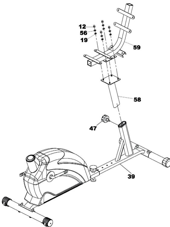
A) Insérez la tige de selle (58) dans le cadre principal arrière (39) et serrez-la à l'aide du bouton de réglage de la tension (47).
