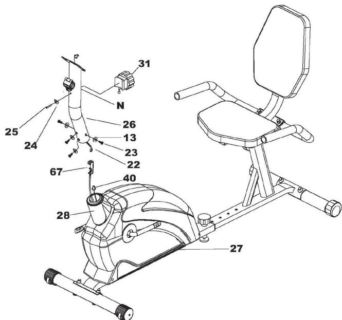
A) Nehmen Sie den vorderen Pfosten (26) und verbinden Sie das mittlere Computerkabel (22) mit dem unteren Computerkabel (40). Ziehen Sie das untere Spannkabel (67) durch den vorderen Pfosten (26) und aus dem Loch auf der Oberseite heraus. Verbinden Sie dann das untere Spannkabel (67) in Pfeilrichtung mit dem Spannkabel (31). Befestigen Sie dann den Zugknopf mit 1 Unterlegscheibe (24) und Schraube (25).
