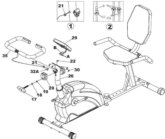
A) Befestigen Sie den Lenker (35) am vorderen Pfosten (26) und ziehen den Lenker und die Lenkerabdeckung (20) mit 1 Unterlegscheibe (19), 1 Distanzstück (18) und der Stellschraube (17) fest. Ziehen Sie den mittleren Impulsdraht (32A) durch die Hülse A (21) und ziehen Sie ihn dann von der Mitte des vorderen Pfostens (26) nach oben.
