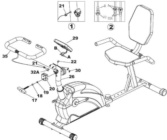
A) Fixez le guidon (35) au montant avant (26) et serrez le guidon et le cache du guidon (20) à l'aide d'une rondelle (19), d'une entretoise (18) et d'une vis de réglage (17). Tirez le câble central du capteur de fréquence cardiaque (32A) à travers le manchon A (21) puis sortez-le du centre du montant avant (26) par le haut.
