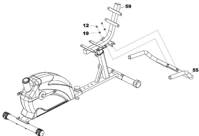
A) Fissare il manubrio della seduta (55) al tubo dell'imbottitura dello schienale (59) con 2 rondelle (19) e 2 dadi ciechi (12).
