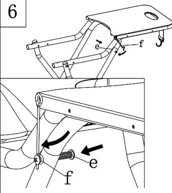
Active el mecanismo de seguridad (f) justo después de abrir el carrito. El carrito dispone de un mecanismo de seguridad automático. Apriete el resorte (e) y enganche el gancho curvado (f) en la extensión del resorte (e). Suelte el resorte. El resorte se extiende y bloquea el mecanismo de seguridad.
