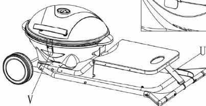
Cuando mueva el carrito plegado o cuando no utilice el aparato, bloquee la tapa con el cierre (W) que se encuentra en la carcasa. Asegúrese de que el cierre (V) está colocado correctamente.
