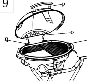
Montez le couvercle. Tenez le couvercle par la poignée (p) et poussez les charnières (O) dans les trous (Q) de la base. Si vous retirez ensuite le couvercle, ouvrez-le à un angle de 45 ° et retirez les charnières (O) des trous (Q). Pour pouvoir retirer le couvercle, il doit être ouvert à un angle de 45 °.
