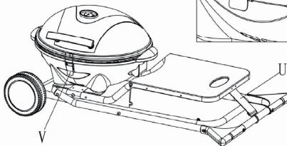
Lorsque vous déplacez le chariot plié ou lorsque la machine n'est pas utilisée, verrouillez le couvercle à l'aide de la boucle (W) située sur le châssis. Assurez-vous que le verrouillage (V) est fermé.
