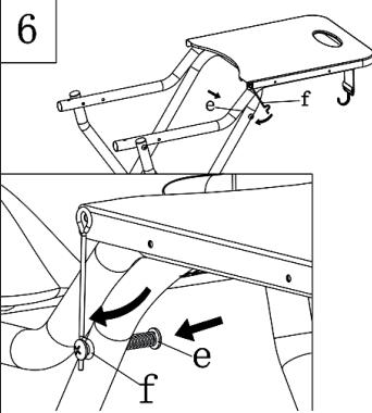
Dès que le chariot est déplié, verrouillez la sécurité (f). Le chariot est équipé d'un verrouillage automatique. Appuyez sur le ressort (e) et attachez le crochet incurvé (f) dans l'extension du (des) ressort (s). Relâchez le ressort. Il sort et bloque le verrou de sécurité.
