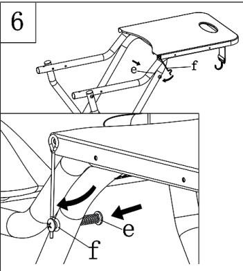
Stellen Sie nach dem Aufklappen des Wagens umgehend die Sicherheitsverriegelung (f) ein. Der Wagen ist mit einer automatischen Verriegelung ausgestattet. Drücken Sie die Feder (e) und haken Sie den gebogenen Haken (f) am in die Verlängerung der Feder (e) ein. Lassen Sie die Feder wieder los. Sie fährt aus, und fixiert die Sicherheitsverriegelung.
