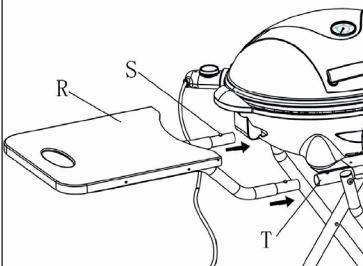
Montieren Sie den Tisch (R). Halten Sie den Tisch (R) fest und drücken Sie die beiden Stifte (S) mit den Daumen herunter. Setzen Sie dann in das Rohr (T) ein. Entfernen Sie später vor dem Zusammenklappen des Wagens zuerst den Tisch (R). Drücken Sie dazu die Stifte (S) herunter und ziehen Sie das Rohr (T) vorsichtig heraus.
