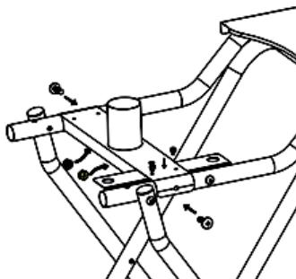
Per prima cosa, togliere la vite dal tubo. Montare il supporto (G1) sul tubo. Montare poi il tubo di sostegno (G2) sul tubo. Sul tubo di sostegno (G2) si trova un foro di posizionamento (IV), a cui verrà poi fissato l'alloggiamento. Stringere il supporto (G1) e il tubo di sostegno (G2) con viti e dadi.
