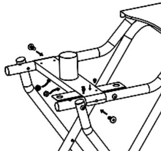
Retirez d'abord la vis du tube. Montez le support (G1) sur le tube. Ensuite, montez le tube de maintien (G2) sur le tube. Un trou de positionnement (IV) se trouve sur le tube de maintien (G2) auquel le boîtier sera fixé ultérieurement. Serrez le support (G1) et le tube de maintien (G2) avec les vis et les écrous.
