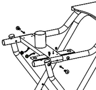
Per prima cosa, togliere la vite dal tubo. Montare il supporto (G1) sul tubo. Montare poi il tubo di sostegno (G2) sul tubo. Sul tubo di sostegno (G2) si trova un foro di posizionamento (IV), a cui verra poi fissato l'alloggiamento. Stringere il supporto (G1) e il tubo di sostegno (G2) con viti e dadi.
