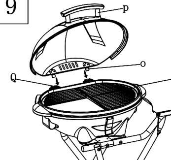
Monte la tapa. Sujete la tapa por el asa (p) e inserte las bisagras (O) en los orificios (Q) de la base. Cuando desee retirar la tapa, ábrala en un ángulo de 45° y desatornille las bisagras (O) de los orificios (Q). Para retirar la tapa, esta tiene que encontrarse en un ángulo de 45°.
