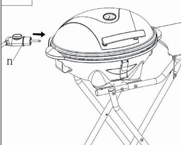
Introduzca el pin (n) del regulador de temperatura extraíble en la entrada correspondiente. Ahora, conecte la clavija a la toma de corriente. A la hora de retirar el regulador de temperatura, sujetelo por el cuerpo del enchufe y no por el cable.
