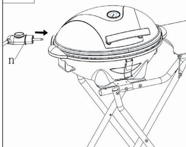
Insérez la (les) broche (s) du régulateur amovible de température dans le connecteur. Vous pouvez maintenant brancher la fiche dans la prise. Si vous retirez le thermostat amovible ultérieurement, maintenez-le fermement par la base, ne tirez pas sur le câble.
