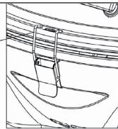
Wenn Sie den zusammengeklappten Wagen bewegen oder das Gerät nicht in Gebrauch ist, verriegeln Sie den Deckel mit der Schnalle (W), die sich am Gehäuse befindet. Vergewissern Sie sich, dass der Riegel (V) fest sitzt.
