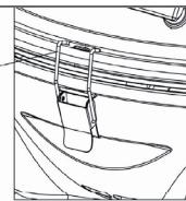
Cuando mueva el carrito plegado o cuando no utilice el aparato, bloquee la tapa con el cierre (W) que se encuentra en la carcasa. Asegúrese de que el cierre (V) está colocado correctamente.
