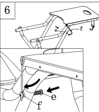
Dès que le chariot est déplié, verrouillez la sécurité (f). Le chariot est équipé d'un verrouillage automatique. Appuyez sur le ressort (e) et attachez le crochet incurvé (f) dans l'extension du (des) ressort (s). Relâchez le ressort. Il sort et bloque le verrou de sécurité.
