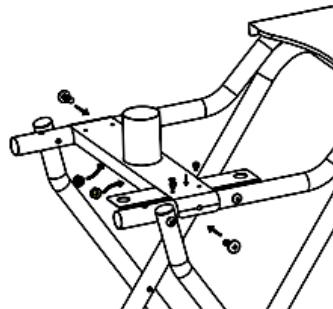
Desatornille los tornillos del tubo. Monte el soporte (G1) en el tubo. A continuación, monte el tubo de soporte (G2) en el tubo. En el tubo de soporte (G2) hay un orificio de posicionamiento (IV) sobre el que se fija más tarde la carcasa. Atornille el soporte (G1) y el tubo de soporte (G2) con los tornillos y las tuercas.
