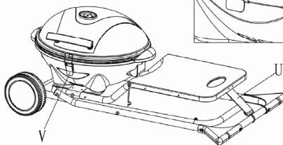
Lorsque vous déplacez le chariot plié ou lorsque la machine n'est pas utilisée, verrouillez le couvercle à l'aide de la boucle (W) située sur le châssis. Assurez-vous que le verrouillage (V) est fermé.
