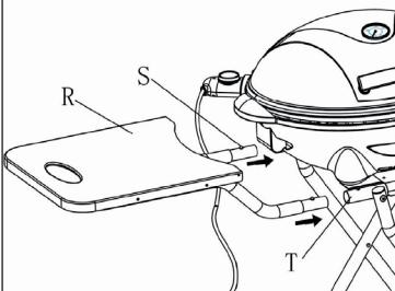
Montez la table (R). Tenez fermement la table (R) et appuyez avec les pouces sur les deux goupilles (S). Puis insérez-la dans le tube (T). Plus tard, avant de plier le chariot, retirez d'abord la table (R). Pour ce faire, appuyez sur les goupilles (S) et retirez avec précaution le tube (T).
