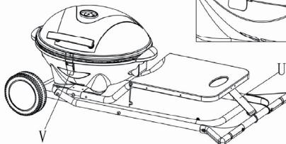
Se si sposta il carrello quando è chiuso o se il dispositivo non è in utilizzo, fissare il coperchio con la clip (W) sull'alloggiamento. Assicurarsi che il blocco (V) sia fissato saldamente.
