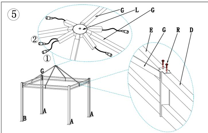
Die Seite des oberen Anschlusses mit den 2 Verbindungen muss zum Rohr B zeigen.
