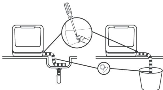
Encaje el extremo del tubo de desagüe a un fregadero o a un cubo. Fije el tubo de desagüe con ventosas.
