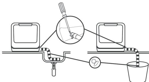
Inserire l'estremità del tubo di scarico in un lavandino o in un secchio. Fissare il tubo di drenaggio con delle ventose.
