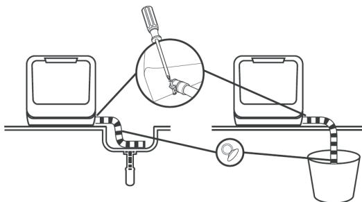
Insérez l'extrémité du tuyau de vidange dans un évier ou un seau. Fixez le tuyau de vidange avec des ventouses.
