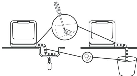
Stecken Sie das Ende des Ablaufschlauchs in eine Spüle oder einen Eimer. Fixieren Sie den Ablaufschlauch mit Saugnäpfen.
