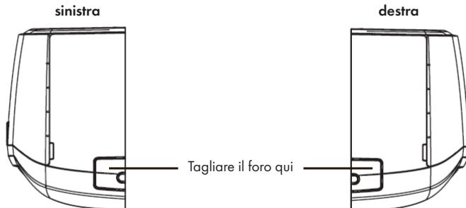
Se si intende dislocare il tubo a sinistra o a destra, tagliare il rispettivo foro sul lato inferiore del dispositivo.
