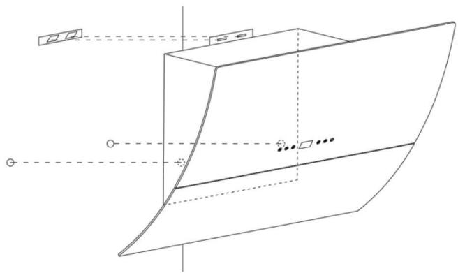
Per modelli inclinati è necessario realizzare altri due fori (8 mm) prima del montaggio. Inserire tasselli e viti, prima di posizionare la cappa sulla parete.
