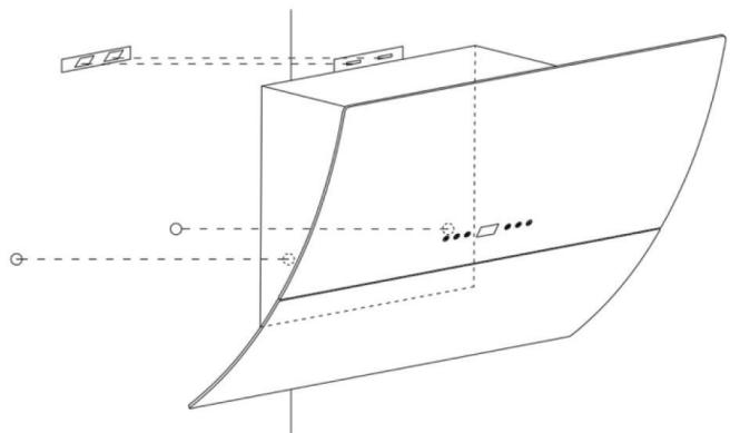
Für Modelle mit schräger Ausführung müssen Sie vor der Montage zwei zusätzliche Löcher (8 mm) bohren. Setzen Sie Dübel und Schrauben ein, bevor Sie die Dunstabzugshaube ab der Wand aufhängen.
