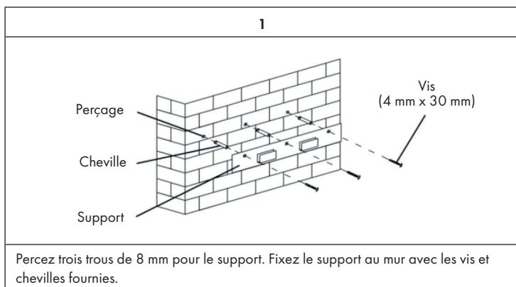
Percez trois trous de 8 mm pour le support. Fixez le support au mur avec les vis et chevilles fournies.
