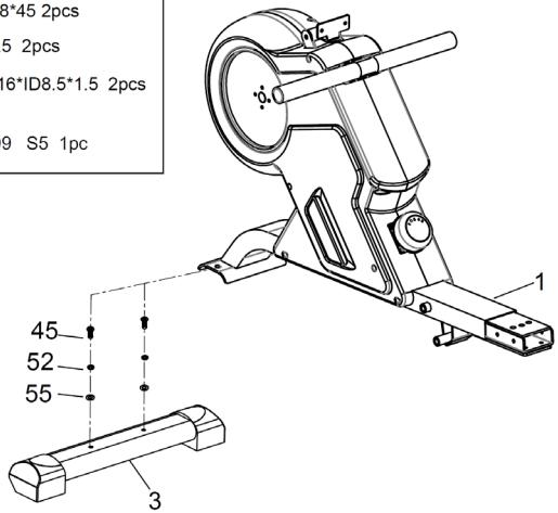
Conecte el tubo estabilizador frontal (#3) al marco principal (#1) usando 2 arandelas (#55), 2 arandelas elásticas (#52) y 2 tornillos de cabeza cilíndrica (#45).
