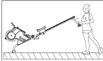
Om de machine te verplaatsen, zet u de achterste stabilisator omhoog totdat de transportwielen aan de voorste standaard de grond raken. Met de wielen op de vloer kunt u de roeitrainer gemakkelijk naar de gewenste plaats vervoeren.
