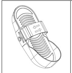
La correa del pedal es ajustable y se puede ajustar al tamaño del pie del usuario.
