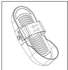
De pedaalriem is verstelbaar en kan worden aangepast aan de voetomvang van de gebruiker.
