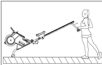
Um die Maschine zu bewegen, heben Sie den hinteren Stabilisator an, bis die Transportrollen auf dem vorderen Ständer den Boden berühren. Mit den Rädern auf dem Boden können Sie das Rudergerät problemlos an den gewünschten Ort transportieren.
