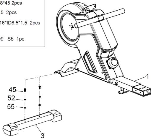
Befestigen Sie das vordere Stabilisatorrohr (#3) mit 2 Unterlegscheiben (#55), 2 Federscheiben (#52) und 2 Inbusschrauben (#45) am Hauptrahmen (#1).
