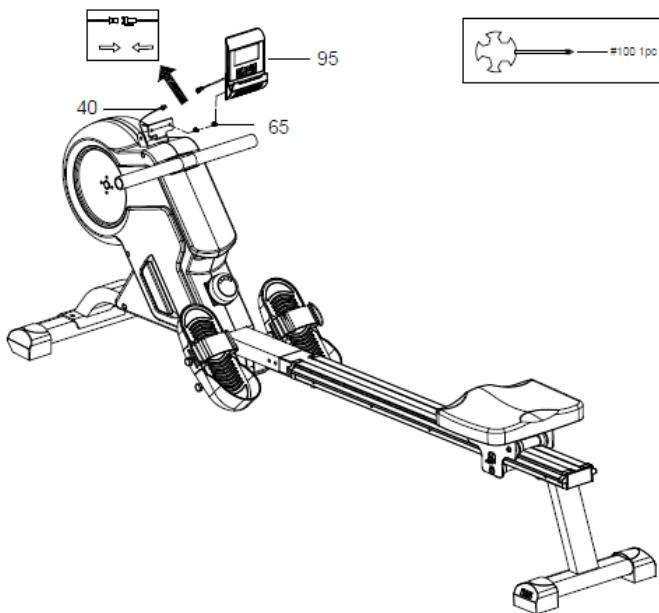
Verwijder de 2 kruiskopschroeven (#65) die voorgemonteerd zijn aan de achterkant van de console (#95). Verbind de sensordraden (#40) met de sensordraden aan de achterkant van de console (#95).
