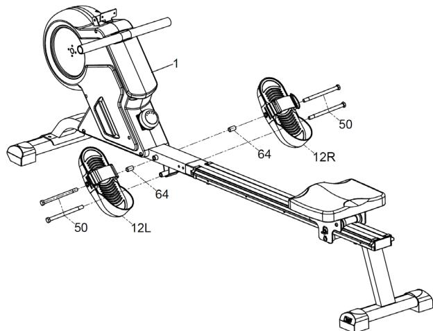
Duw de zeskantbout (#50) door het linker pedaal (#12L) en de huls (#64) en bevestig deze aan het bovenste boorgat van het hoofdframe (#1). Schroef nog een zeskantbout (#50) in het onderste boorgat van het hoofdframe (#1). Herhaal de stappen voor het rechter pedaal (#12R).
