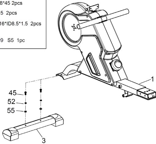
Fixez le tube du stabilisateur avant (n ° 3) au cadre principal (n ° 1) à l'aide de 2 rondelles (n ° 55), 2 rondelles à ressort (n ° 52) et 2 vis Allen (n ° 45).
