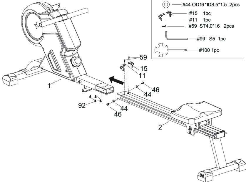
Plaats de glijrail (#2) in het hoofdframe (#1), draai de rail vast met 4 kruiskopschroeven (#92).
