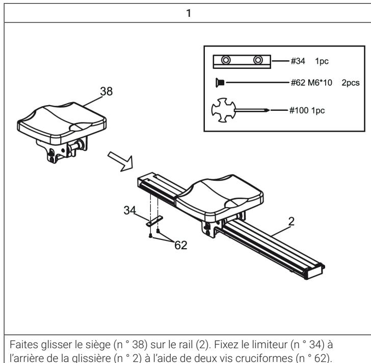
Faites glisser le siège (n ° 38) sur le rail (2). Fixez le limiteur (n ° 34) à l'arrière de la glissière (n ° 2) à l'aide de deux vis cruciformes (n ° 62).
