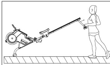
Per spostare il dispositivo, sollevare il supporto (38), fino a quando le rotelle sul tubo di appoggio anteriore (6) toccano il pavimento. Ora è possibile spostare il vogatore al luogo desiderato senza problemi.
