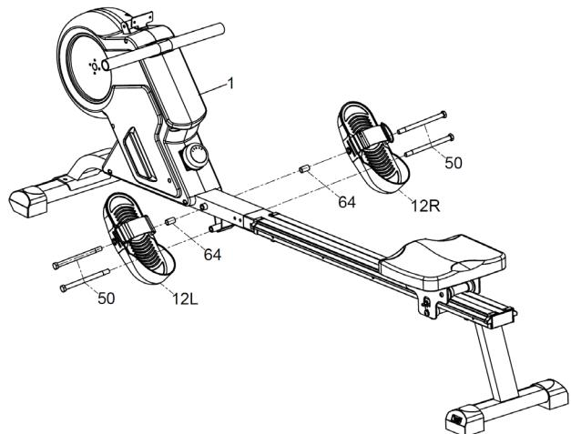
Faites glisser la vis Allen (n ° 50) à travers la pédale gauche (n ° 12L) et le manchon (n ° 64) et fixez-la au trou supérieur du cadre principal (n ° 1). Vissez une autre vis Allen (n ° 50) dans le trou inférieur du cadre principal (n ° 1). Répétez les étapes pour la pédale droite (# 12R).
