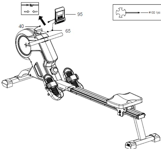
Entfernen Sie die 2 Kreuzschlitzschrauben (#65), die auf der Rückseite der Konsole (#95) vormontiert sind. Verbinden Sie die Sensordrähte (#40) mit den Sensordrähten an der Rückseite der Konsole (#95).
