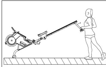
Para mover la máquina, levante el carro trasero (38) hasta que los rodillos de transporte del tubo vertical delantero (6) toquen el suelo. Con las ruedas en el suelo, usted puede transportar fácilmente la máquina de remo a la ubicación deseada.
