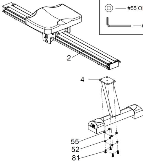
Fissare il tubo di supporto posteriore (4) alla guida di scorrimento (2) e stringere saldamente con 4 rondelle (55), 4 rondelle elastiche (52) e 4 viti a brugola (81).
