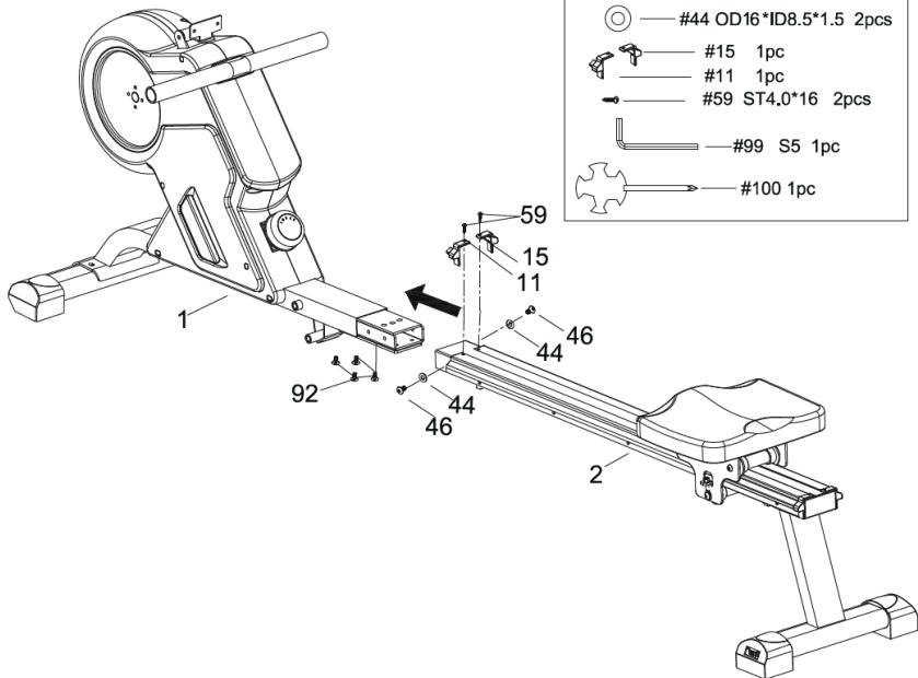
Setzen Sie die Gleitschiene (#2) in den Hauptrahmen (#1) ein, ziehen Sie die Gleitschiene mit 4 Kreuzschlitzschrauben (#92) fest.
