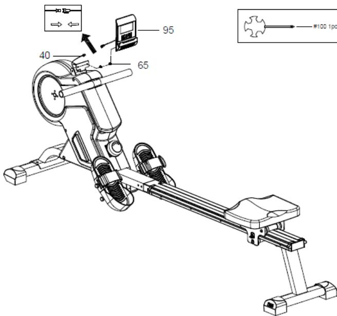
Retire los 2 tornillos Phillips (#65) que están premontados en la parte posterior de la consola (#95). Conecte los cables del sensor (# 40) a los cables del sensor en la parte posterior de la consola (# 95).
