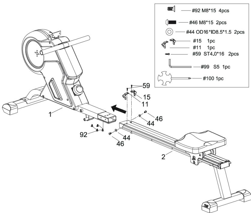
Inserire la guida di scorrimento (2) nel telaio principale (1) e stringere saldamente con 2 rondelle (44), 2 viti a brugola (46) e 4 viti a brugola (92).
