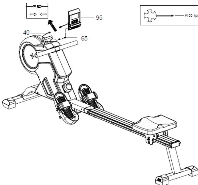
Togliere le 2 viti a croce (65) premontate sul retro della consolle (95). Collegare i cavi del sensore (40) con i cavi del sensore sul retro della consolle (95).
