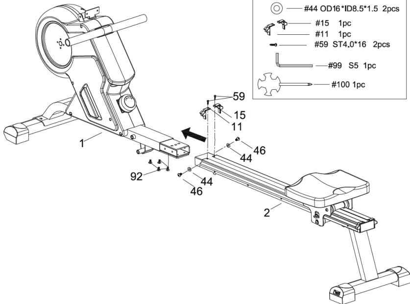
Insérez la glissière (# 2) dans le cadre principal (# 1), puis serrez avec 4 vis Allen (# 92).
