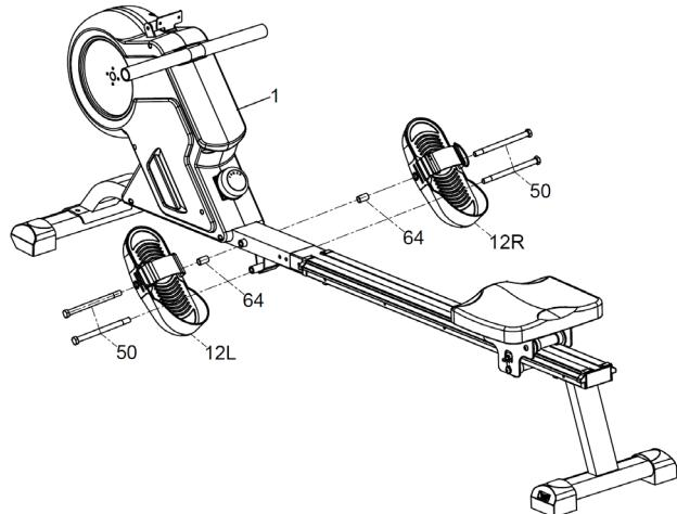
Schieben Sie die Sechskantschraube (#50) durch das linke Pedal (#12L) und die Hülse (#64) und befestigen Sie sie an der oberen Bohrung des Hauptrahmens (#1). Schrauben Sie eine weitere Sechskantschraube (#50) in die untere Bohrung des Hauptrahmens (#1). Wiederholen Sie die Schritte für das rechte Pedal (#12R).
