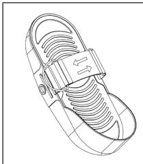
Der Pedalriemen ist verstellbar und kann an die Fußgröße des Benutzers angepasst werden.
