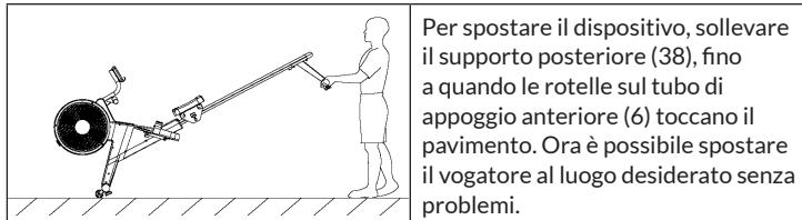
Per spostare il dispositivo, sollevare il supporto posteriore (38), fino a quando le rotelle sul tubo di appoggio anteriore (6) toccano il pavimento. Ora è possibile spostare il vogatore al luogo desiderato senza problemi.
