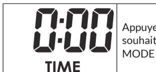
Appuyez sur UP ou DOWN pour régler la durée souhaitée (1:00 à 99:00 minutes) et appuyez sur MODE pour confirmer.
