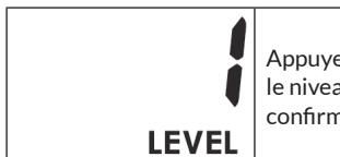
Appuyez sur UP ou DOWN pour sélectionner le niveau (de 1 à 32) et appuyez sur MODE pour confirmer..
