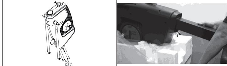
Las 4 tuercas de nailon (87) se han preinstalado en la parte inferior de la estructura principal (1). Quite la tuerca de nailon (87).
