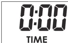
Presione la tecla UP o DOWN para ajustar la hora deseada (1:00 a 99:00 minutos) y presione MODE para confirmar
