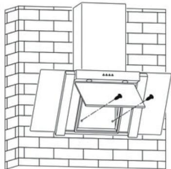
Fije el conducto de humos inferior con dos tornillos de 4 x 8 mm.
