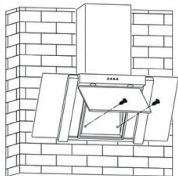
Fixez le conduit de fumée inférieur avec deux vis de 4 x 8 mm.
