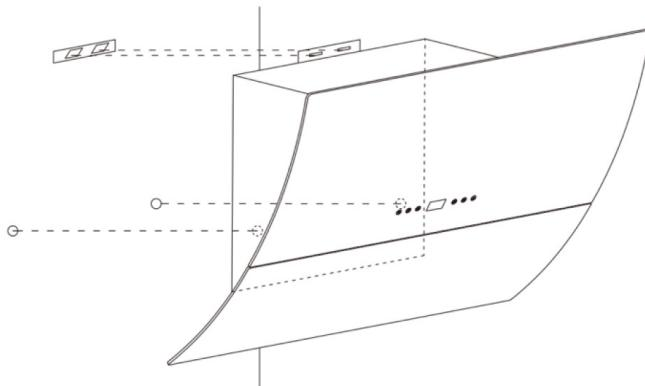
Pour les modèles obliques, vous devez percer quatre trous supplémentaires (8 mm) avant le montage. Insérez les chevilles et les vis avant d'accrocher le capot au mur.
