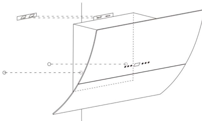
Für Modelle mit schräger Ausführung müssen Sie vor der Montage vier zusätzliche Löcher (8 mm) bohren. Setzen Sie Dübel und Schrauben ein, bevor Sie die Dunabzugshaube ab der Wand aufhängen.
