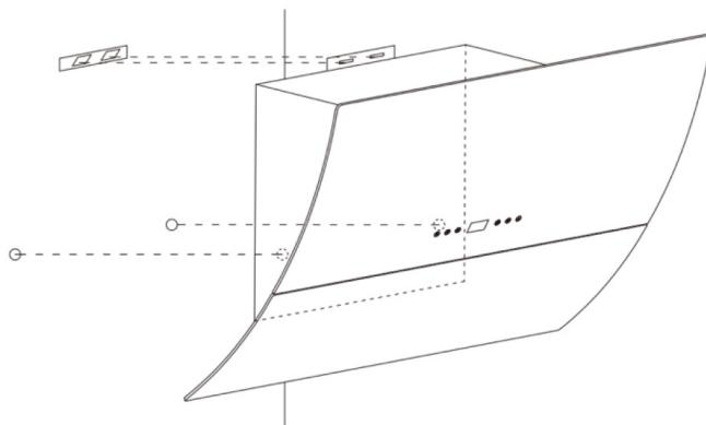
En el caso de los modelos oblicuos, es necesario taladrar cuatro orificios adicionales (8 mm) antes del montaje. Inserte los tacos y tornillos antes de colgar la campana de la pared.
