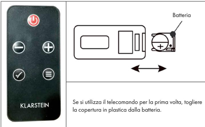
Se si utilizza il telecomando per la prima volta, togliere la copertura in plastica dalla batteria.
