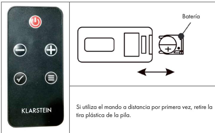
**Nota:** Esta calefacción se entrega con un mando a distancia. Para poder manejar el aparato con el mando a distancia, el interruptor principal (A) debe estar colocado en la posición ON. Todos los botones del mando a distancia tienen las mismas funciones que los botones del panel de control.
