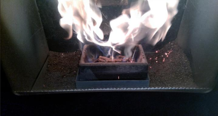
Bei korrekter Verbrennung, wie auf dem unteren Bild dargestellt, ist der Aschebehälter praktisch leer. Die (sauerstoffreich) Flamme funkelt weiß und verfärbt das Glas nicht.
