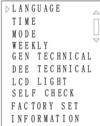
Utilisez les touches et pour accéder à l'un des éléments de menu suivants : LANGUAGE (langue), TIME (heure), MODE (mode), WEEKLY (hebdomadaire), GEN TECHNICAL (GEN technique), DEE TECHNICAL (DEE technique), LCD LIGHT (éclairage LCD), SELF CHECK (autocontrôle), FACTORY SET (réglage d'usine), INFORMATION (informations). Appuyez sur la touche SET pour accéder à l'élément de menu.
