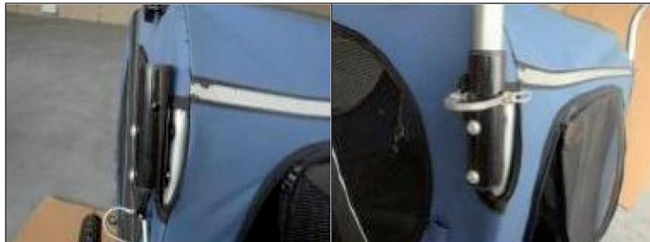
Fissare i due tubi dell'impugnatura al telaio sul retro. Orientare i fori sul tubo dell'impugnatura all'estremità aperta del tubo di montaggio. Avvitare le viti attraverso il tubo e i fori. Fissare le viti dall'interno della cabina con dadi. Stringere viti e dadi con un cacciavite e una chiave inglese. Inserire le estremità del manubrio nei tubi di fissaggio, orientare i fori, inserire i perni di bloccaggio e fissarli.
