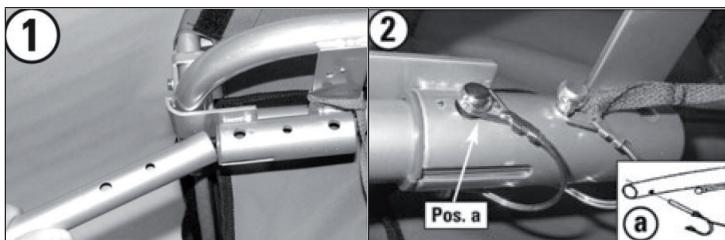
Para fijar el acoplamiento del remolque, inserte el extremo redondo en el soporte diseñado para tal fin (imagen 1) en la parte izquierda. Asegure la barra insertada con el cierre rápido suministrado (Pos. a) y el pasador de seguridad (imagen 2). La curvatura en el acoplamiento del remolque está ahora dirigida hacia la derecha con respecto a la dirección de marcha.
