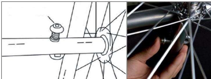
Inserire la parte esterna dell'asse delle ruote nella parte interna dell'asse. Le ruote sono fissate quando si sente che la molla sul tubo dell'asse di innesta. Le ruote possono essere tolte semplicemente premendo il tasto sul meccanismo a molla sul lato inferiore dell'asse e staccandole dal tubo dell'asse.
