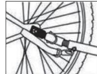
Mettere in sicurezza il collegamento con la cinghia, avvolgendolo una volta intorno al telaio della bici (assicurarsi che non finisca nei raggi) e fissarlo al componente del rimorchio della barra di traino.
