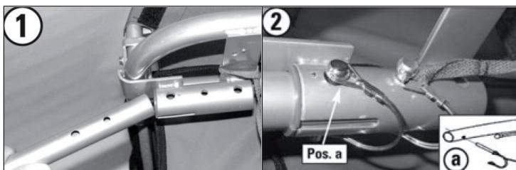
Pour installer l'attelage, faites glisser l'extrémité arrondie dans le support prévu (Fig. 1) du côté gauche. Bloquez le timon inséré à l'aide du dispositif de verrouillage rapide fourni (Élément a) et de la goupille de verrouillage (Figure 2). L'attelage de remorque est maintenant courbé vers la droite par rapport au sens de la marche.
