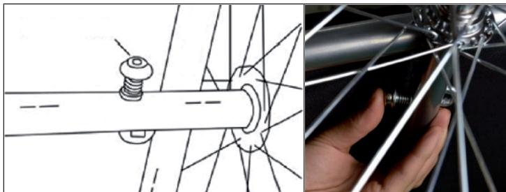
Insérez la partie extérieure de l'essieu dans la partie intérieure. Les roues sont bloquées lorsque vous les sentez enclenchées dans la suspension du tube d'essieu. Les roues se retirent simplement du tube d'essieu en appuyant sur la touche du mécanisme à ressort situé sous l'essieu.
