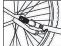
Asegure la conexión al cinturón de seguridad envolviéndolo una vez alrededor del cuadro de la bicicleta (asegúrese de que no entre en los radios) y fijándolo en la parte del remolque de la barra de tracción.
