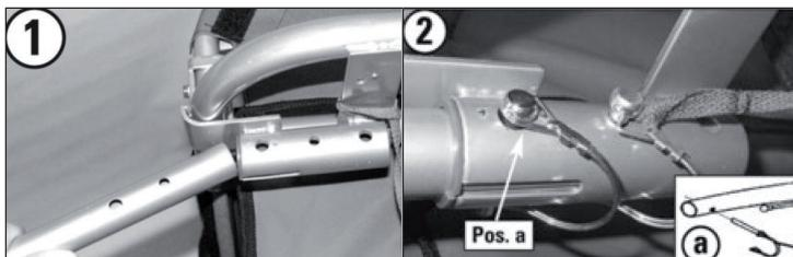
Zur Befestigung der Anhängerkupplung schieben Sie das runde Ende in die dafür vorgesehene Aufnahme (Bild 1) auf der linken Seite. Sichern Sie die eingesetzte Deichsel mit dem mitgelieferten Schnellspanner (Pos.a) und dem Sicherungsstift (Bild 2). Die Krümmung in der Anhängerkupplung ist nun in Bezug auf die Fahrtrichtung nach rechts gerichtet.
