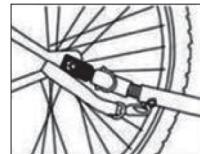
Sécurisez la fixation avec la sangle de sécurité en l'enroulant autour du cadre du vélo (assurez-vous qu'elle n'entre pas dans les rayons) et fixez-la à la partie support de la barre de traction.
