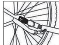
Sichern Sie die Verbindung mit dem Sicherheitsgurt, indem Sie diesen einmal um den Fahrradrahmen wickeln (achten Sie darauf, dass er nicht in die Speichen gerät) und am Hänger-Teil der Ziehstange befestigen.
