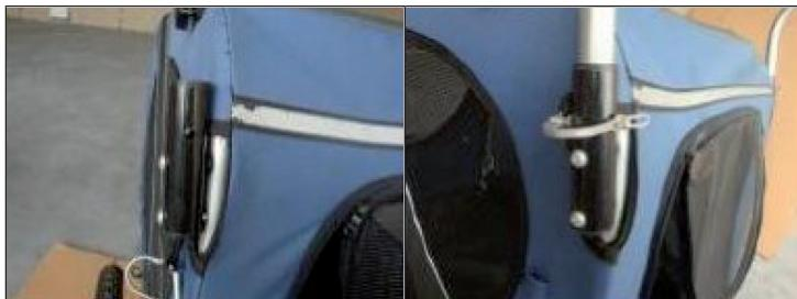
Fije los dos tubos de soporte al cuadro en la parte trasera. Alinee los orificios del tubo de soporte con el extremo abierto del tubo de montaje. Atornille los tornillos a través del tubo y los orificios. Asegure los tornillos con tuercas desde el interior de la cabina. Apriete los tornillos y tuercas con un destornillador y una llave. Deslice los extremos del manillar en los tubos de montaje, alinee los orificios, inserte y bloquee los pasadores de seguridad.
