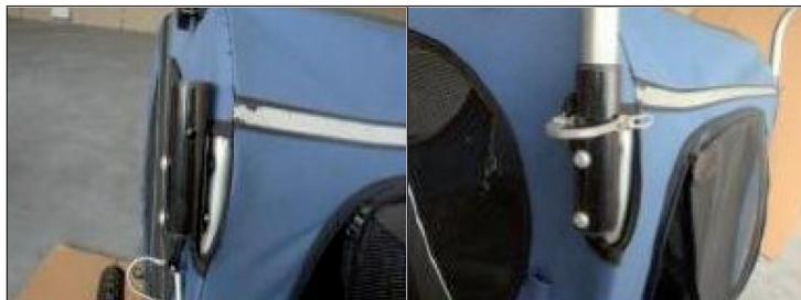
Fixez les deux tubes support à l'arrière du cadre. Alignez les trous du tube support avec l'extrémité ouverte du tube de montage. Serrez les vis à travers le tube et les trous. Bloquez les vis de l'intérieur de la cabine avec des écrous. Serrez les vis et écrous avec un tournevis et une clé. Insérez les extrémités du guidon dans les tubes de montage, alignez les trous, insérez les goupilles de verrouillage et verrouillez-les.
