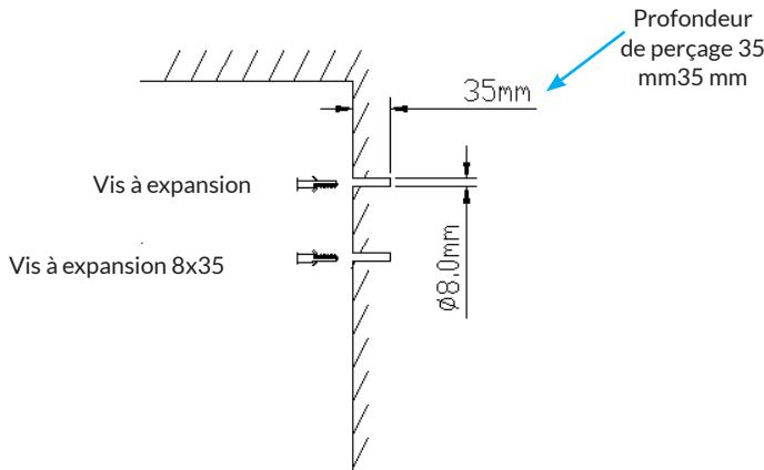
Étape 2 : Fixez le support au mur dans le sens de la flèche.
