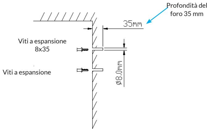
Passaggio 2: fissare la staffa fissa sul muro, come punti della freccia.
