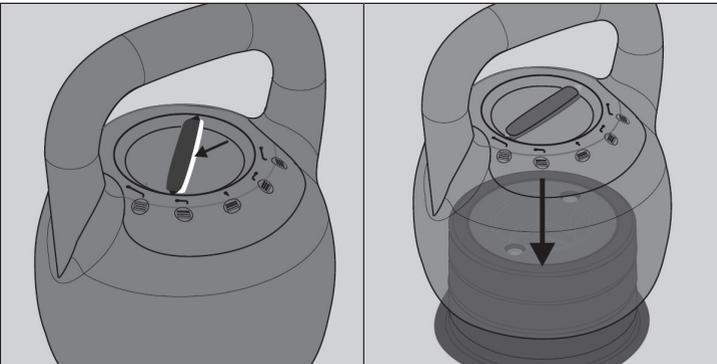
Wenn sich die Einstelluntertasse in der Verriegelungsposition befindet, sollten Sie den inneren Hebel (gelb) nicht sehen können. Wenn der innere Hebel sichtbar ist, stellen Sie den äußeren Hebel leicht ein, und die Einstelluntertasse springt ab.
