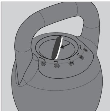
Lorsque la soucoupe de réglage se trouve en position de verrouillage, vous ne devez pas voir le levier intérieur (jaune). Si vous pouvez voir le levier intérieur, ajustez légèrement le levier extérieur pour que la soucoupe de réglage s'ouvre.
