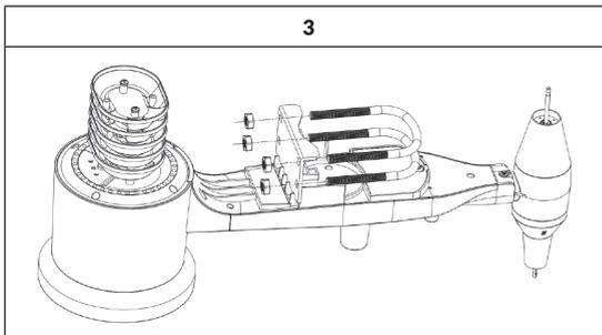
Apriete solo ligeramente las tuercas en el extremo del perno en U. Puede apretar las tuercas después de finalizar la instalación (para el último paso de instalación, véase ilustración 4).
