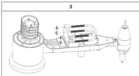
Ruotare liberamente il dado sull'estremità dei bulloni a U. È possibile serrare i dadi dopo aver completato l'installazione (ultima fase di installazione, vedere la Figura 4).
