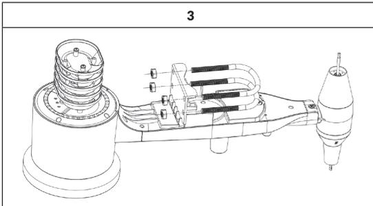
Tourner légèrement l'écrou sur l'extrémité des boulons en U. Vous pouvez serrer les écrous une fois l'installation terminée (voir dernière étape de l'installation 4).
