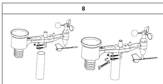
**Nota:** Junto a la antena se encuentra un símbolo de flecha con la inscripción „WEST“ (véase ilustración 9) que representa el punto cardinal oeste. El aparato se ha adaptado de tal modo que el indicador „WEST“ se oriente en dirección al norte real. Se recomienda utilizar una brújula para determinar el punto cardinal correcto. Existirá un error en la dirección del viento permanente si el sensor exterior no se instala en la dirección correcta.
