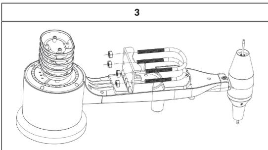
Drehen Sie die Mutter locker auf das Ende der U-Bolzen. Sie können die Mutter nach dem Beenden der Installation festziehen (letzter Installationsschritt siehe Abbildung 4).
