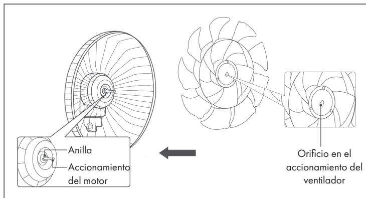
Extraiga el cabezal del ventilador del embalaje. Sujete las aspas del ventilador con una mano y, con la otra, apriete el tirador del ventilador en sentido antihorario.
