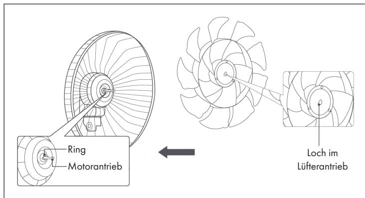
Nehmen Sie den Lüfterknopf aus der Verpackung. Halten Sie die Lüfterblätter mit der einen Hand und drehen Sie den Lüfterknopf mit der anderen Hand gegen den Uhrzeigersinn fest.
