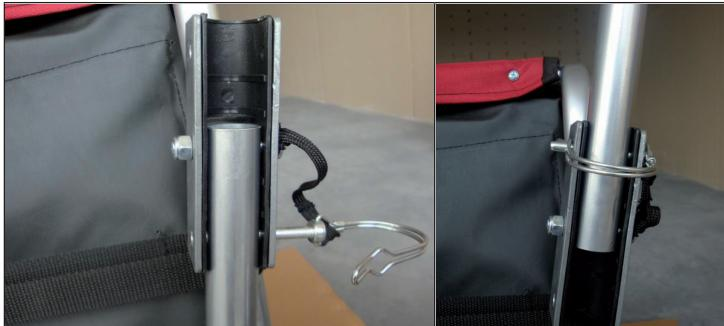
Heben Sie den Anhänger an. Entfernen Sie den Sicherheitsstift aus der hinteren Bohrung. Schwenken Sie die Anhängerkupplung um 180°. Verriegeln Sie die Anhängerkupplung, indem Sie den Sicherheitsstift wieder einsetzen.
