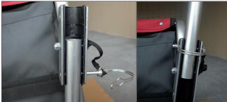
Levante el remolque. Retire el pasador de seguridad del agujero trasero. Gire el enganche del remolque 180°. Bloquee el enganche del remolque reinsertando el pasador de seguridad.
