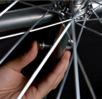
La imagen muestra una mano izquierda sujetando la rueda trasera por el eje central. La rueda tiene un neumático negro con un patrón de cinta. La mano derecha pulsa los botones de liberación del eje, permitiendo que la rueda sea retirada. |
