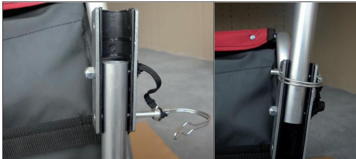
Soulevez la remorque. Retirez la goupille de sécurité du trou arrière. Faites pivoter l'attelage de 180 °. Verrouillez l'attelage en replaçant la goupille de sécurité.
