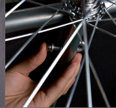
A close-up photograph showing a hand pulling a bicycle wheel away from a hub. The wheel is black with a thick tread pattern. The hub is silver and attached to a dark grey frame. The background is a solid green color. <p>Um das Rad zu entfernen, heben Sie den Anhänger hoch, drücken Sie die Drucktasten an der Achse und entfernen Sie das Rad (siehe Abbildung).</p> |
