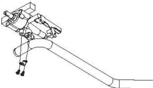
Befestigen Sie den Gasschlauch mit einer Schelle und zwei Schrauben (M5x12) am Ventil des Gasgrills.
