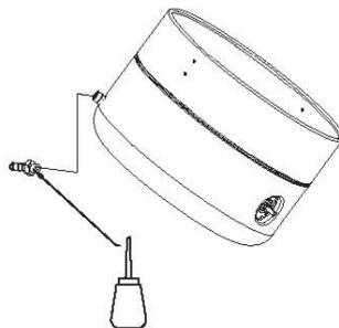
Tragen Sie etwas Dichtungskleber auf das Anschlussgewinde auf und befestigen Sie dann den Anschluss am Gasschlauch und drehen Sie ihn fest.
