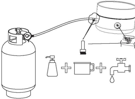
Schließen Sie, nachdem der Dichtungkleber getrocknet ist, das Ventil und die Gaszufuhr vollständig. Prüfen Sie mittels einer Seifenlösung, ob Gaslecks vorhanden sind. Geben Sie Seifenlösung auf die Verbindung von Grillventil und Anschluss.
