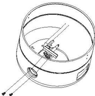
Montieren Sie die Ventilbaugruppe mit zwei Schrauben (M4x8) am Regler und richten Sie die Ventilbaugruppe so aus, dass der Grill über den Drehknopf gezündet werden kann.
