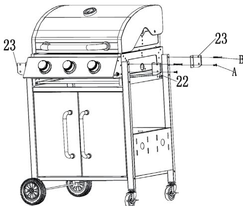
Vis et accessoires nécessaires : A x 4 &amp; B x 4
