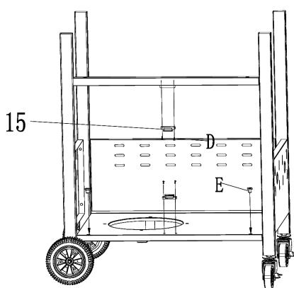
Vis et accessoires nécessaires: D x 4 &amp; E x 2
