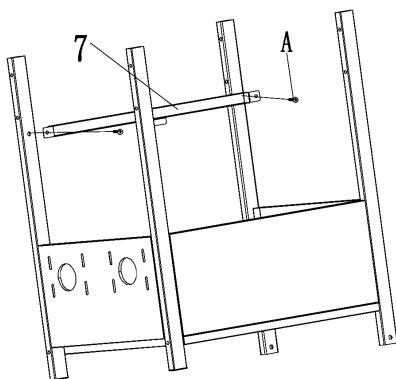
Vis et accessoires nécessaires : A x 2
