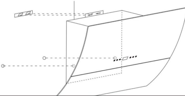
En el caso de los modelos oblicuos, es necesario taladrar cuatro orificios adicionales (8 mm) antes del montaje. Inserte los tacos y tornillos antes de colgar la campana de la pared.
