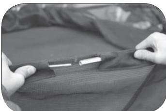
Empuje las dos varillas metálicas largas en el bolsillo superior de la red de seguridad como se muestra en la imagen.
