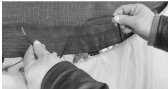
Utilizzare la corda per unire la parte inferiore della rete di protezione con gli anelli triangolari come da figura.
