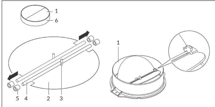
Si vous disposez d'une évacuation vers l'extérieur, vous pouvez installer la hotte aspirante comme sur l'image de droite. Le conduit d'évacuation doit avoir un diamètre de 150 mm minimum et être en émail, aluminium ou en matériau flexible et résistant à la chaleur.
