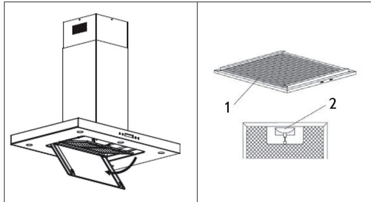
**Entfernen Sie den Filter wie auf dem Bild dargestellt und setzen Sie ihn dann in umgekehrter Reihenfolge wieder ein.**
