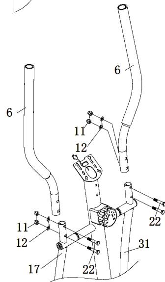
Fije las empuñaduras (6L) y (6R) con tornillos (22), arandelas (12) y tuercas (11) a los manillares inferiores (17) y (31).
