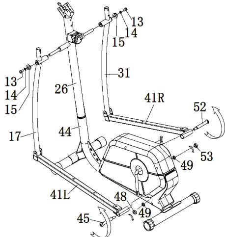
Fije los manillares inferiores (17) y (31) con tornillos (13), arandelas (14) y arandelas con forma de D (15) en los postes verticales (26). Fije los tubos de los pedales (41L) y (41R) con los tornillos de la junta del pedal (45) y (52), arandelas elásticas (49) y las tuercas (48) y (53) en los postes laterales (26).
