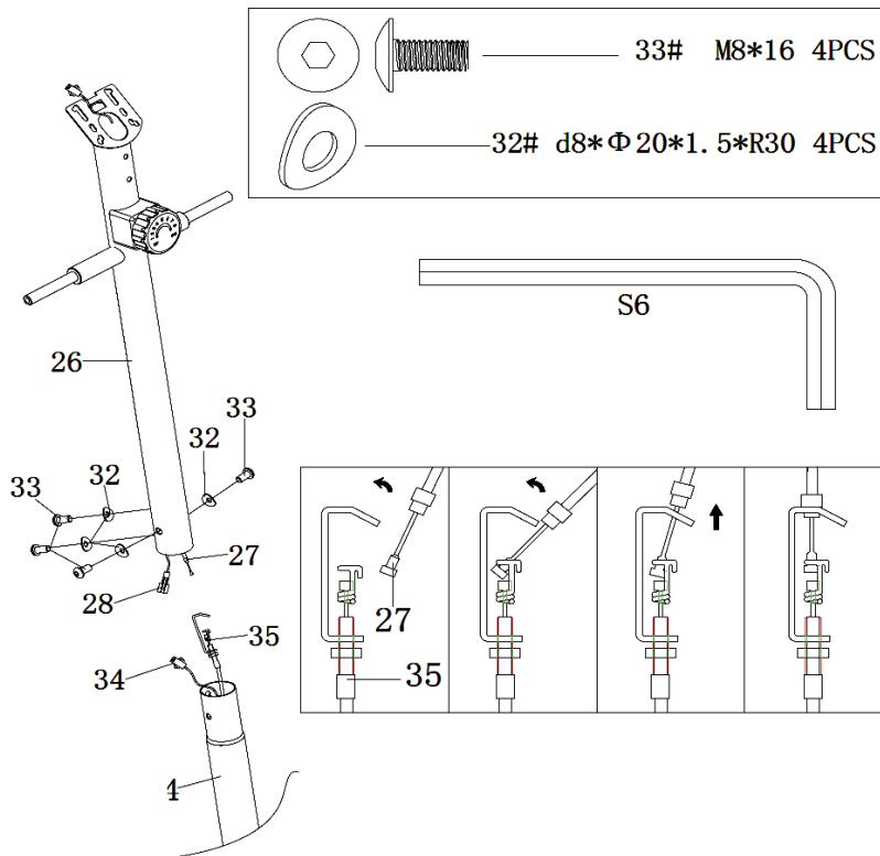
Conecte los cables del sensor (28) y (34), además de los cables de control de tracción (27) y (35). Fije los postes verticales (26) con tornillos (33) y arandelas (32) al marco principal (44).
