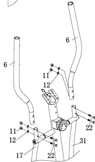
Fissare le impugnature (6L) e (6R) alle aste di impugnatura inferiori (17) e (31) con viti (22), rondelle (12) e dadi (11).
