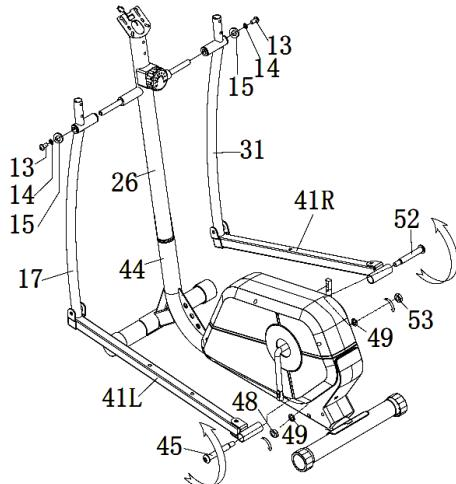
Attachez les guidons inférieurs (17) et (31) au montant vertical (26) à l'aide des vis (13), des rondelles (14) et des rondelles en forme de D (15). Attachez les tubes de pédales (41L) et (41R) au montant vertical (26) avec les vis de joint de pédale (45) et (52), les rondelles à ressort (49) et les écrous (48) et (53).
