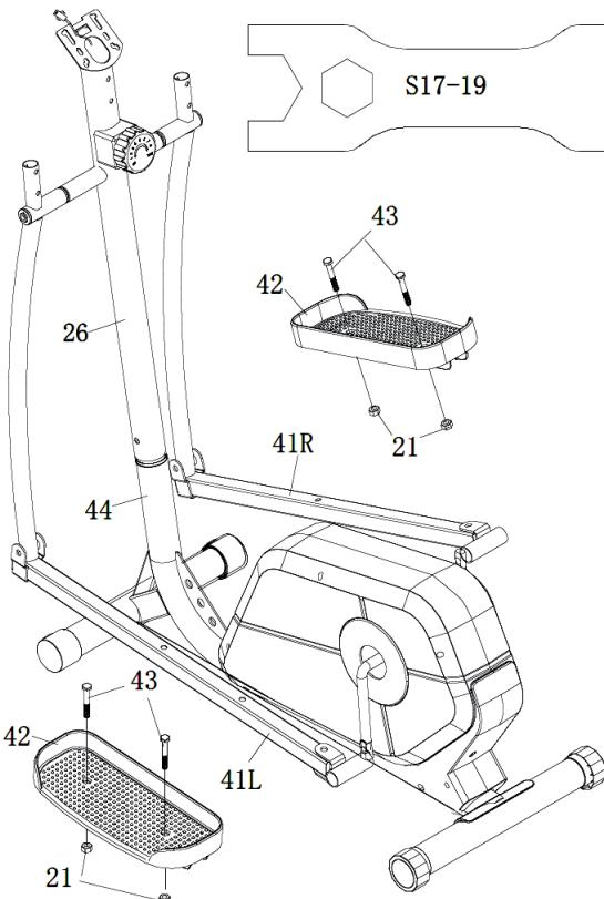
Fissare i pedali (42) ai tubi dei pedali (41L) e (41R) con viti esagonali (43) e dadi (21).
