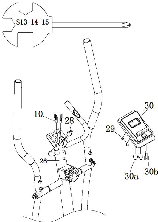
Collegare il cavo d'impulso dell'impugnatura (10) e (30a) e collegare poi il cavo del sensore (28) al computer (30b). Fissare poi il computer al supporto (26) con la vite (29).
