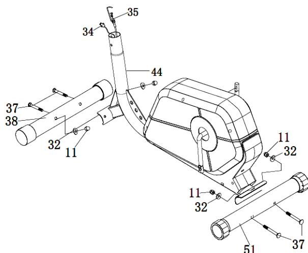
Fije el estabilizador delantero (38) y el estabilizador trasero (51) con los tornillos (37), las tuercas (11) y las arandelas (32) a la estructura principal (44).
