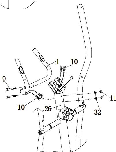
Connectez les câbles du capteur (10). Attachez le guidon (1) au montant vertical (26) avec les Vis (9), les rondelles (32) et les écrous (11).
