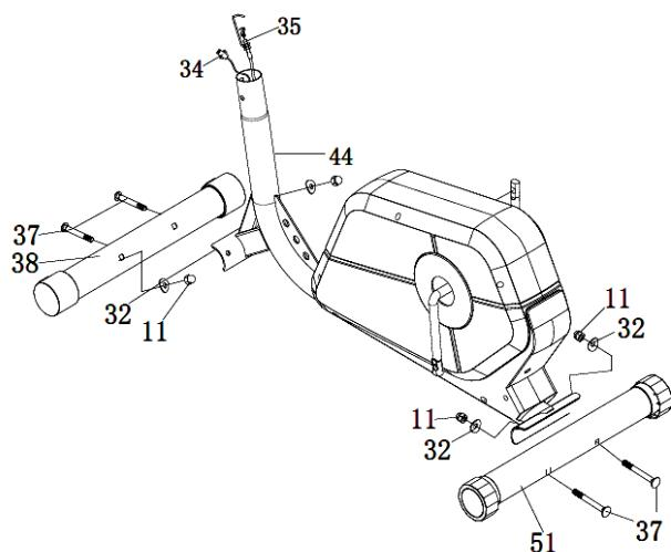
Fixez les stabilisateurs avant (38) et arrière (51) au cadre principal (44) à l'aide des vis (37), des écrous (11) et des rondelles (32).
