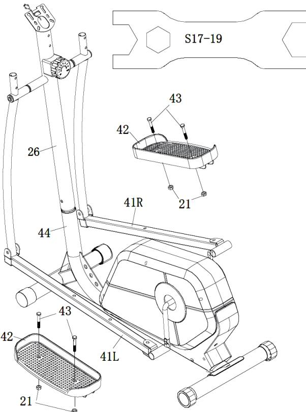
Fixez les pédales (42) aux tubes des pédales (41L) et (41R) avec des vis hexagonales (43) et des écrous (21).
