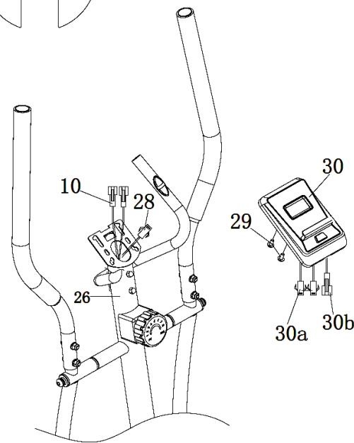
Connectez le fil de pulsations de poignée (10) et (30a), puis connectez le fil du capteur (28) à l'ordinateur (30b). Enfin, fixez l'ordinateur (30) avec la vis (29) sur le montant (26).
