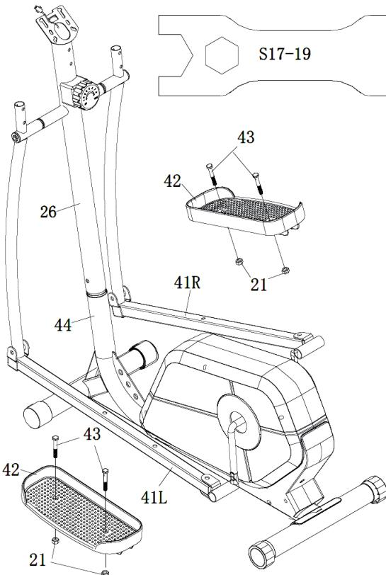
Fije los pedales (42) con tornillos hexagonales (43) y tuercas (21) a los tubos de los pedales (41L) y (41R).
