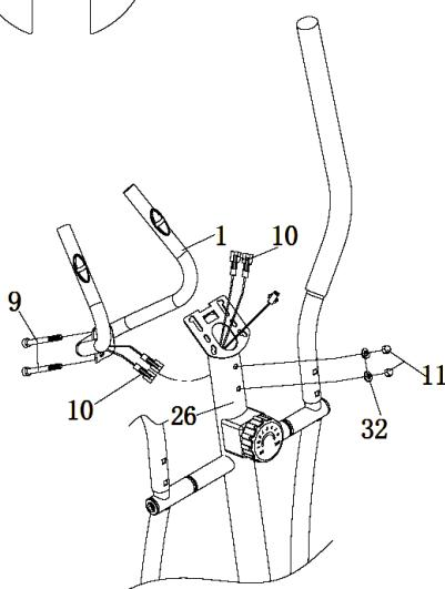
Verbinden Sie die Sensorkabel (10). Befestigen Sie den Lenker (1) mit Schrauben (9), Unterlegscheiben (32) und Muttern (11) am aufrechten Pfosten (26).
