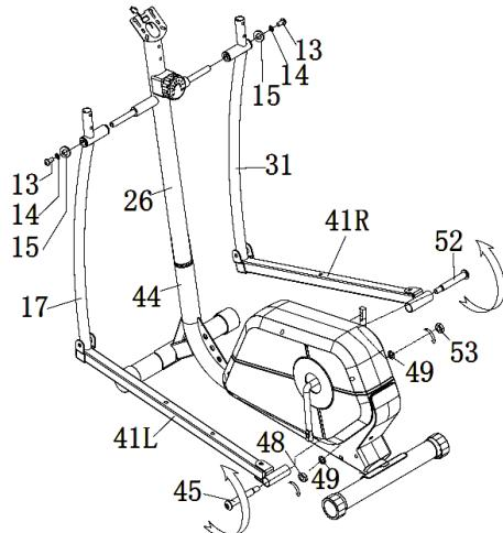
Fissare le aste di impugnatura inferiori (17) e (31) alla colonna verticale (26) con viti (13), rondelle (14) e rondelle a forma di D (15). Fissare i tubi dei pedali (41L) e (41R) alla colonna verticale (26) con le viti per le articolazioni dei pedali (45) e (52), le rondelle (49) e i dadi (48) e (53).
