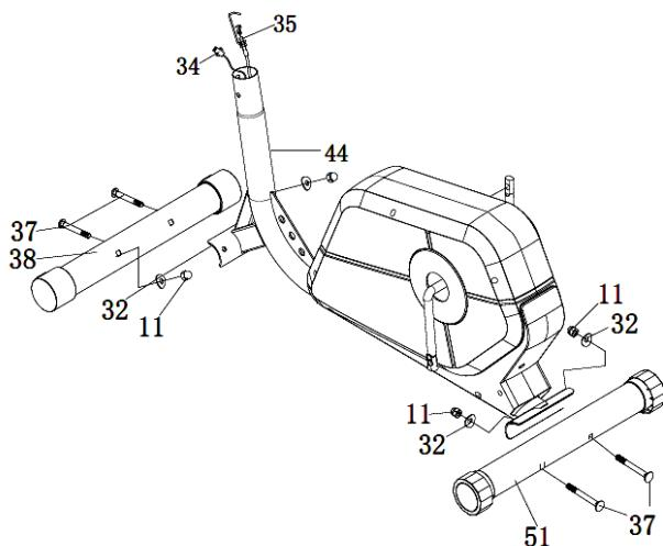
Befestigen Sie den vorderen Stabilisator (38) und den hinteren Stabilisator (51) mit Schrauben (37), Muttern (11) und Unterlegscheiben (32) am Hauptrahmen (44).
