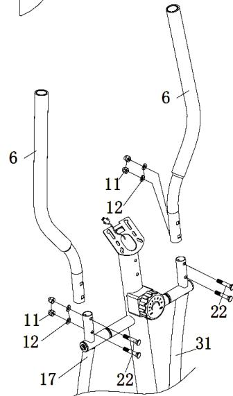
Befestigen Sie die Griffe (6L) und (6R) mit Schrauben (22), Unterlegscheiben (12) und Muttern (11) an den unteren Griffstangen (17) und (31).
