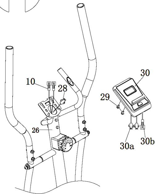
Schließen Sie den Griffimpulsdraht (10) und (30a) an und verbinden Sie dann den Sensordraht (28) mit dem Computer (30b). Befestigen Sie zum Schluss den Computer (30) mit der Schraube (29) am Ständer (26).
