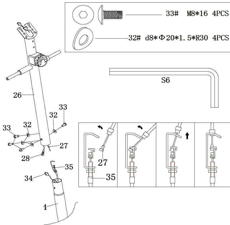
Collegare i cavi del sensore (28) e (34) e i cavi di controllo di trazione (27) e (35). Fissare la colonna verticale (26) al telaio principale (44) con viti (33) e rondelle (32).
