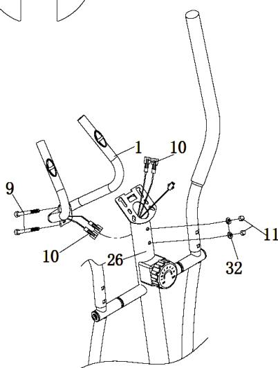
Collegare il cavo del sensore (10). Fissare il manubrio alla colonna verticale (26) con viti (9) rondelle (32) e dadi (11).
