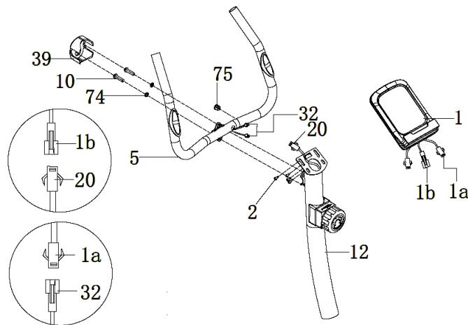
Befestigen Sie den Lenker (5) mit einer Unterlegscheibe (74) und einer Schraube (10) am Stützrohr (12). Verbinden Sie den Computerdraht (1b) mit dem Sensorkabel (20). Verbinden Sie den Computerdraht (1a) mit dem Griffimpulsdraht (32). Befestigen Sie die Konsole (1) mit Schrauben (2) am Stützrohr (12). Bringen Sie dann die kleine Abdeckung (39) am Lenker (5) an.
