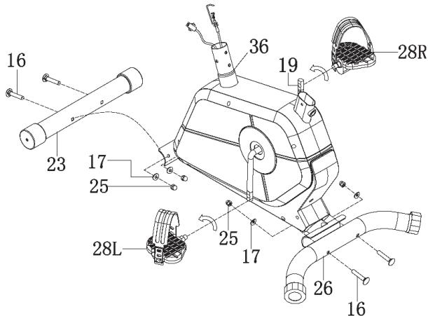
Befestigen Sie den vorderen Stabilisator (23) und den hinteren Stabilisator (26) mit Schrauben (16), Muttern (25) und Unterlegscheiben (7) am Hauptrahmen (36). Befestigen Sie die Pedale (28L) und (28R) an den Kurbelarmen.
