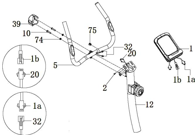
Fissare il manubrio (5) al tubo di supporto (12) con una rondella (74) e una vite (10). Collegare il cavo del computer (1b) al cavo del sensore. Collegare il cavo del computer (1a) con il cavo delle impugnature per misurare la frequenza cardiaca (32). Fissare la console (1) al tubo di sostegno (12) con le viti (2). Montare poi la copertura piccola (39) sul manubrio (5).
