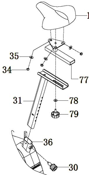
Inserire il reggisella (31) nel telaio principale (36) e allineare i fori. Fissare il sedile con la manopola di regolazione (30). Fissare il sedile (11) alla staffa del sedile (77) con un dado (34) e una rondella (35). Fissare la staffa della sella (77) al tubo della sella (31) con una rondella (78) e una manopola (79). L'altezza corretta del sedile può essere regolata dopo che la bicicletta è completamente assemblata.
