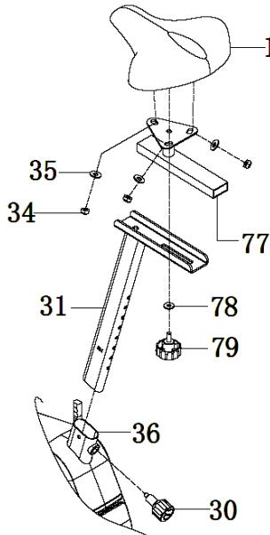
Stecken Sie die Sattelstütze (31) in den Hauptrahmen (36) und richten Sie die Löcher aneinander aus. Fixieren Sie den Sitz mit dem Einstellknopf (30). Befestigen Sie den Sitz (11) mit einer Mutter (34) und einer Unterlegscheibe (35) an der Sitzhalterung (77). Befestigen Sie die Sitzhalterung (77) mit einer Unterlegscheibe (78) und dem Knopf (79) am Sitzrohr (31). Die richtige Höhe für den Sitz kann eingestellt werden, nachdem das Fahrrad vollständig zusammengebaut ist.
