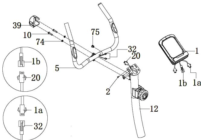
Fije el manillar (5) al tubo de soporte (12) con una arandela (74) y un tornillo (10). Una el cable del ordenador (1b) al cable del sensor (20). Una el cable del ordenador (1a) con el cable de impulso del manillar (32). Fije la consola (1) con tornillos (2) al tubo de apoyo (12). Posteriormente, coloque la cubierta pequeña (39) en el manillar (5).
