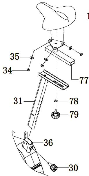
Insérez la tige de siège (31) dans le cadre principal (36) et alignez les trous. Fixez le siège à l'aide du bouton de réglage (30). Fixez le siège (11) au support du siège (77) avec un écrou (34) et une rondelle (35). Fixez le support de selle (77) au tube de selle (31) avec une rondelle (78) et un bouton (79). La hauteur correcte du siège peut être réglée après le montage complet du vélo.
