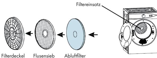
Ziehen Sie den Filtereinsatz an der Rückseite des Innenraums ab. Der Filtereinsatz besteht aus 3 Filtern.
