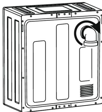
Befestigen Sie Abluftanschluss am Trockner, indem Sie ihn festdrehen. Befestigen Sie dann den Abluftschlauch am Abluftanschluss.
