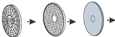
Wenn Sie die Filter gereinigt haben, setzen Sie sie in umgekehrter Reihenfolge wieder ein. Versichern Sie sich, dass die Filter fest sitzen.
