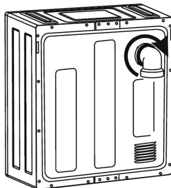
Fixez le raccord d'échappement au sèche-linge en le serrant. Fixez ensuite le tuyau d'échappement au raccord d'échappement.
