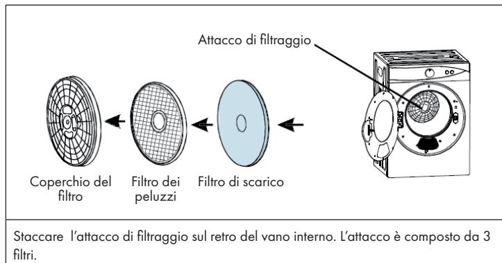
Staccare l'attacco di filtraggio sul retro del vano interno. L'attacco è composto da 3 filtri.
