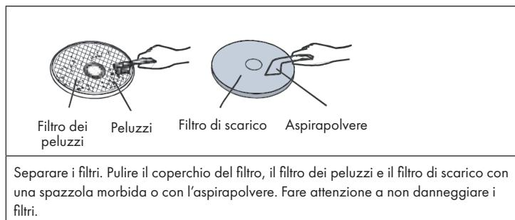
Separare i filtri. Pulire il coperchio del filtro, il filtro dei peluzzi e il filtro di scarico con una spazzola morbida o con l'aspirapolvere. Fare attenzione a non danneggiare i filtri.
