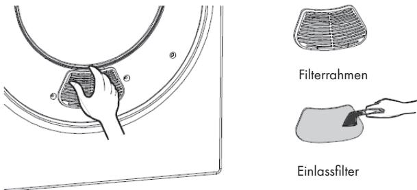
Reinigen Sie den Lufteinlassfilter einmal im Monat. Entfernen Sie den Filter, indem Sie das untere und oberer Ende des Rahmens festhalten und ihn herausziehen. Reinigen Sie den Einlassfilter mit einer weichen Bürste. Setzen Sie den Filter dann wieder in den Rahmen und befestigen Sie den Rahmen.
