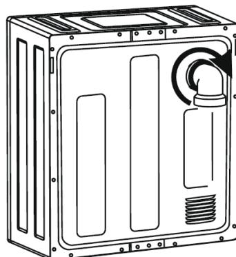
Fissare il connettore del tubo di scarico dell'aria all'asciugatrice ruotandolo. Fissare poi il tubo di scarico al connettore.
