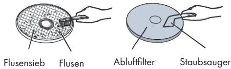
Trennen Sie die Filter. Reinigen Sie den Filterdeckel, das Flusensieb und den Abluftfilter mit einer weichen Bürste oder dem Staubsauger. Achten Sie darauf, die Filter dabei nicht zu beschädigen.
