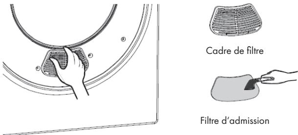
Nettoyez le filtre d'entrée d'air une fois par mois. Retirez le filtre en tenant le bas et le haut du cadre et en le tirant. Nettoyez le filtre d'entrée avec une brosse douce. Remettez ensuite le filtre dans le cadre et fixez le cadre.
