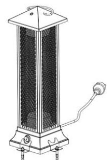
Bohren Sie vier Löcher in den Boden, befestigen Sie die Heizstrahler mit vier Keilbolzen am Boden und ziehen Sie die Schrauben mit einem Schraubenschlüssel fest.
