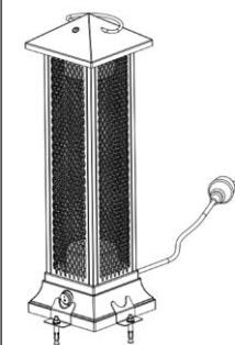
Taladre cuatro agujeros en el suelo, sujeté los calentadores con cuatro pernos de cuña y apriete los tornillos con una llave inglesa apretada.
