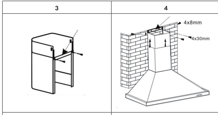
Tirer sur la partie supérieure de la cheminée jusqu'à atteindre la hauteur nécessaire. Une fois que la cheminée a la hauteur exacte, la fixer à la barre de fixation (cf. flèche) avec deux vis de  $4 \times 8$  mm.
