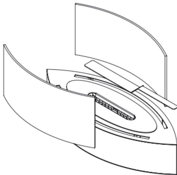
Setzen Sie die Seitenwände in die dafür vorgesehenen Schlitze am Sockel ein.
