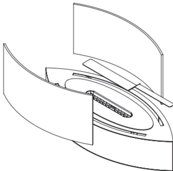
Insérez les panneaux latéraux dans les fentes prévues à cet effet sur la base.
