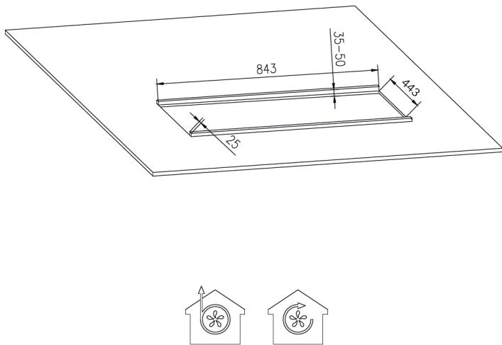
Au-dessus de la cuisinière, vous aurez besoin d'une ouverture dont les dimensions sont indiquées sur le schéma. Renforcez le plafond autour de l'ouverture à l'aide d'un cadre en lattes ou en inox ayant les dimensions indiquées sur le schéma.
