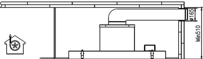
Vous pouvez diriger les gaz de combustion vers une conduite d'évacuation ou bien utiliser la hotte en mode recyclage d'air (schéma d'en haut). Si vous branchez une conduite d'extraction, fixez l'extrémité du tuyau d'extraction à l'évacuation de votre plafond ou mur (schéma d'en bas).
