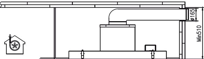
Puede colocar el conducto de extracción hacia el exterior o la campana extractora en modo ventilación (imagen superior). Si extrae el aire, fije el extremo del conducto de extracción a la salida de su techo o pared (imagen inferior).
