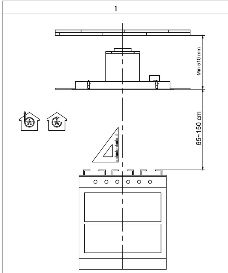
Versichern Sie sich, dass der Abstand von der Herdplatte zur Abzugshaube den angegebenen Abmessungen entspricht. Der Anstand zwischen Herd und Abzugshaube sollte zwischen 65-150 cm liegen.
