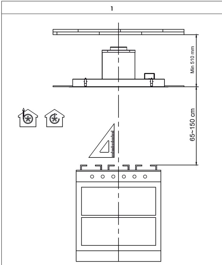
Asegúrese de que la distancia de la placa de cocción a la campana cumpla con las dimensiones indicadas. La distancia entre la placa y la campana extractora debe estar comprendida entre 65 y 150 cm.
