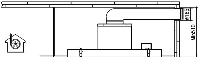
L'aria di scarico può essere espulsa all'esterno oppure la cappa aspirante può essere messa in funzione in modalità ricircolo dell'aria (figura in alto). Durante lo scarico dell'aria, collegare l'estremità del tubo di scarico all'uscita del soffitto o della parete (figura in basso).
