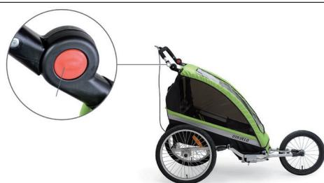
Appuyez sur les boutons rouges de chaque côté et faites pivoter le guidon dans une position confortable. Poussez le guidon vers le haut ou vers le bas pour vous assurer qu'il est verrouillé en place.
