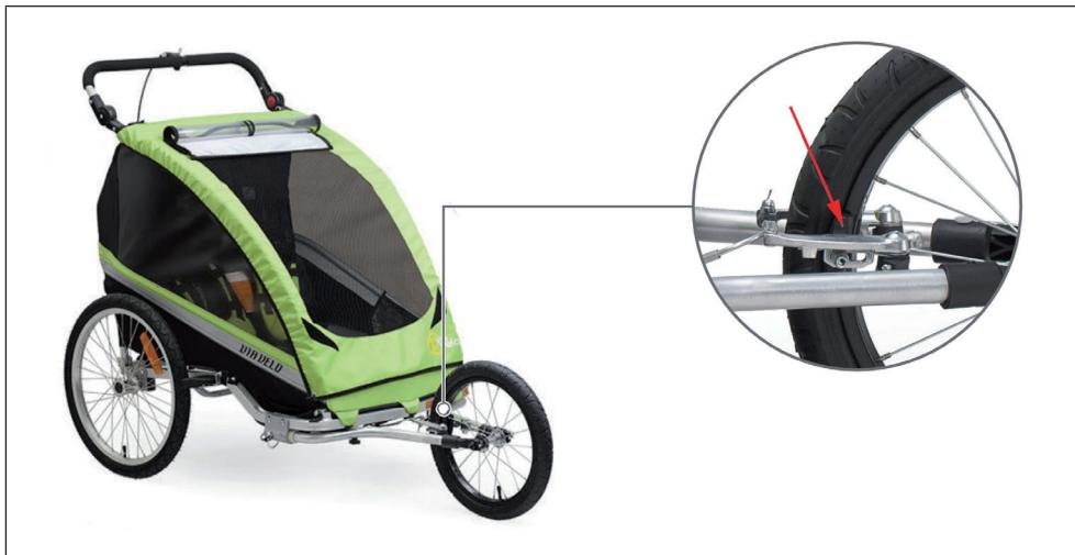
**Nota:** assicurarsi che i pattini dei freni (v. freccia) siano allineati al cerchione in metallo. Se la ruota non si muove in modo lineare, allentare il tensionatore rapido e spostare leggermente la ruota nella fessura per regolarla. Stringere nuovamente il tensionatore rapido e controllare se la ruota si muove ora in modo diritto. Se non è così, ripetere la procedura.
