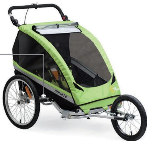
Um die Bremse festzustellen, bewegen Sie den Bremshebel nach außen, bis der den Reifen berührt. Lösen Sie die Bremse, indem Sie den Bremshebel in Richtung Rahmen drücken.
