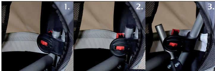
Zum Zusammenklappen Ihres Anhängers öffnen Sie einfach den hinteren Stauraum und öffnen Sie Verriegelungen an den vertikalen Rahmenrohren an.
