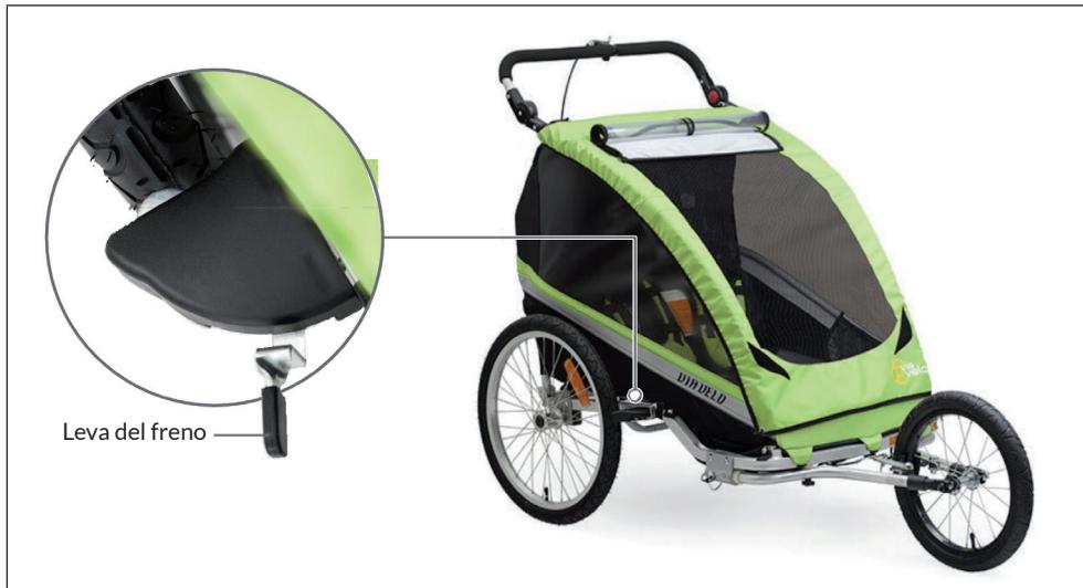
Per attivare i freni, muovere la leva verso l'esterno, fino a quando tocca la gomma. Sganciare il freno premendo la leva verso il telaio.
