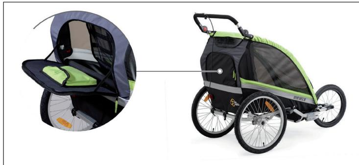
Der Anhänger verfügt über einen Stauraum. Dieser ist nicht für Gegenstände mit einem Gewicht von mehr als 4,5 kg (10 lbs) vorgesehen. Um Zugang zum hinteren Stauraum zu erhalten, öffnen Sie den Reißverschluss an der Rückseite des Anhängers.
