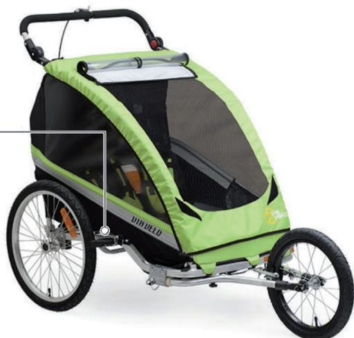
Para activar los frenos, mueva la palanca hacia afuera hasta que toque los neumáticos. Suelte los frenos presionando la palanca de frenos en dirección a la estructura.
