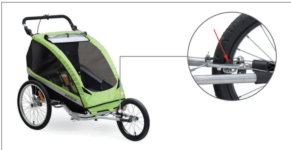
**Remarque :** Assurez-vous que les plaquettes de frein (voir flèche) sont alignées avec la jante métallique. Si la roue n'est pas droite, desserrez le dispositif de blocage rapide et faites glisser légèrement la roue dans la fente pour la régler. Resserrez le blocage rapide et vérifiez que la roue est bien droite. Sinon, répétez la procédure.
