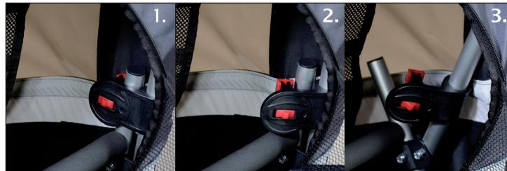
Para plegar el remolque, solamente tiene que abrir el espacio de almacenamiento trasero y desenganchar los cierres de las barras verticales de la estructura.
