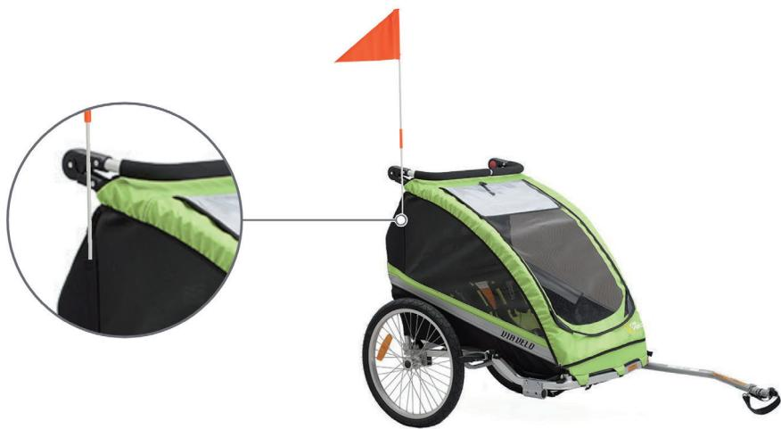
Encaje el extremo de la bandera de seguridad en el pequeño casquillo situado en la parte derecha del remolque.
