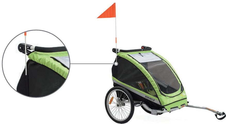
Insérez l'extrémité du drapeau de sécurité dans le petit manchon sur le côté droit de la remorque.
