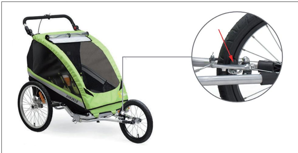
**Advertencia:** asegúrese de que las zapatas de freno (véase flecha) estén alineadas con la llanta metálica. Si la rueda no se desplaza recta, suelte el cierre rápido y desplácela ligeramente hacia la ranura para ajustar la rueda. Vuelva a apretar el cierre rápido y compruebe que la rueda sí se desplaza recta. En caso contrario, repita el proceso.
