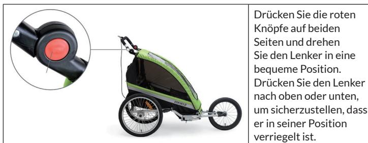
Drücken Sie die roten Knöpfe auf beiden Seiten und drehen Sie den Lenker in eine bequeme Position. Drücken Sie den Lenker nach oben oder unten, um sicherzustellen, dass er in seiner Position verriegelt ist.
