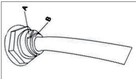
Rimuovi prima l'anello blu (A) e poi premi l'anello bianco (B) all'esterno. Per ultimo rimuovi il tubo di riempimento dell'acqua.
