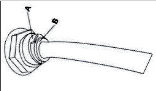
Nehmen Sie zunächst den blauen Ring (A) ab und drücken Sie dann den weißen Ring (B) an der Außenseite. Entnehmen Sie als Letztes die Füllwasserleitung.
