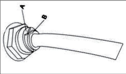
Commencez par retirer la bague bleue (A), puis appuyez sur la bague blanche (B) à l'extérieur. Enfin, retirez le tuyau d'admission d'eau.
