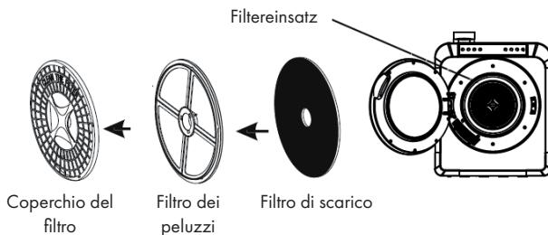
Staccare l'attacco di filtraggio sul retro del vano interno. L'attacco è composto da 3 filtri.
