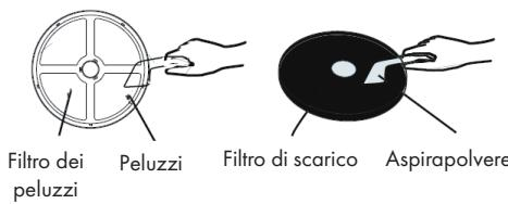
Separare i filtri. Pulire il coperchio del filtro, il filtro dei peluzzi e il filtro di scarico con una spazzola morbida o con l'aspirapolvere. Fare attenzione a non danneggiare i filtri.
