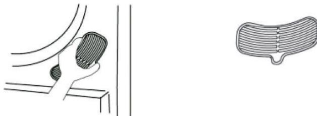
Reinigen Sie den Lufteinlassfilter einmal im Monat. Entfernen Sie den Filter, indem Sie das untere und oberer Ende des Rahmens festhalten und ihn herausziehen. Reinigen Sie den Einlassfilter mit einer weichen Bürste. Setzen Sie den Filter dann wieder in den Rahmen und befestigen Sie den Rahmen.
