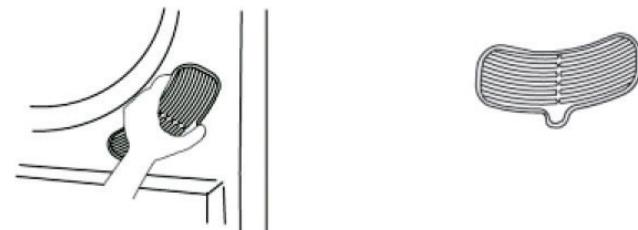
Nettoyez le filtre d'admission d'air une fois par mois. Retirez le filtre en tenant le bas et le haut du cadre et en le tirant. Nettoyez le filtre d'admission avec une brosse douce. Puis replacez le filtre dans le cadre et fixez-le.
