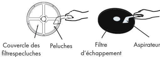
Séparez les filtres. Nettoyez le couvercle du filtre, le filtre à peluches et le filtre d'échappement avec une brosse douce ou l'aspirateur. Veillez à ne pas endommager les filtres.
