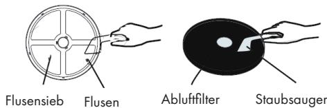
Trennen Sie die Filter. Reinigen Sie den Filterdeckel, das Flusensieb und den Abluftfilter mit einer weichen Bürste oder dem Staubsauger. Achten Sie darauf, die Filter dabei nicht zu beschädigen.
