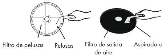
Retire el filtro. Limpie la tapa del filtro, el filtro de pelusas y el filtro de salida de aire con un cepillo suave o una aspiradora. Asegúrese de no dañar el filtro.
