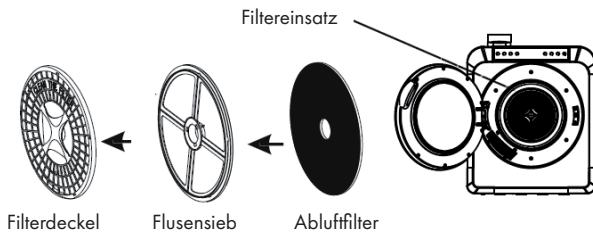
Ziehen Sie den Filtereinsatz an der Rückseite des Innenraums ab. Der Filtereinsatz besteht aus 3 Filtern.
