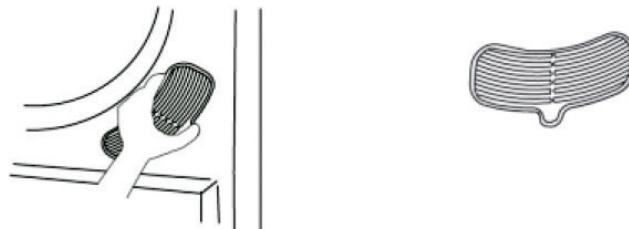
Pulire il filtro di ingresso dell'aria una volta al mese. Togliere il filtro tenendo saldamente le estremità superiore e inferiore del filtro e tirandolo fuori. Pulire il filtro di ingresso con una spazzola morbida. Riposizionare il filtro nel telaio e fissarlo.
