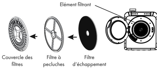
Retirez l'élément filtrant à l'arrière à l'intérieur. L'élément filtrant est constitué de 3 filtres.
