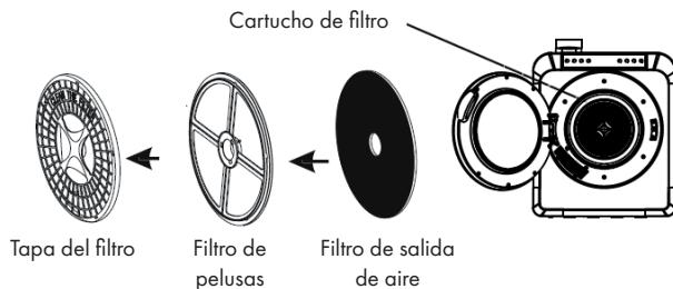
Retire el cartucho de filtro de la parte posterior del interior. El cartucho de filtro se compone de 3 filtros.
