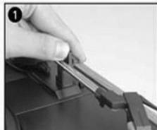
Drücken Sie zum Entschlüsseln des Tonarms die Tonarmsicherung
