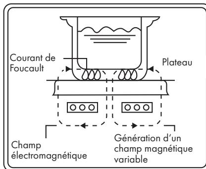
Lorsque l'appareil est branché sur le secteur, le courant électrique crée un champ magnétique dans la bobine d'induction intégrée à l'appareil. Dès que les lignes de champ magnétique touchent la casserole / la marmite en alliage d'acier, la chaleur est produite et chauffer les aliments dans la casserole.
