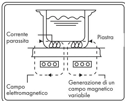
Quando il dispositivo è collegato all'alimentazione, la corrente elettrica genera un campo magnetico nella bobina di induzione che si trova nel dispositivo. Non appena le linee magnetiche del campo toccano la pentola in lega d'acciaio, si forma l'effetto riscaldante, che porta al riscaldamento degli alimenti nella pentola.
