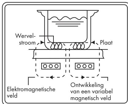
Wanneer de voeding op het toestel wordt aangesloten, wekt de elektrische stroom een magnetisch veld op in de inductiespoel die ingebouwd is in het toestel. Zodra de magnetische veldlijnen van het magnetisch veld de pot/pan van gelegeerd staal raken, treedt het verwarmende effect op, dat leidt tot een verwarming van het voedsel in de pan.
