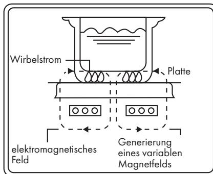
Wenn der Stromanschluß an das Gerät angeschlossen ist, erzeugt der elektrische Strom ein Magnetfeld in der Induktionsspule, die in das Gerät eingebettet ist. Sobald die magnetischen Feldlinien des Magnetfeldes den Topf/Kessel aus legiertem Stahl berühren, entsteht der Heizeffekt, der zu einer Erwärmung der Lebensmittel im Topf führen würde.
