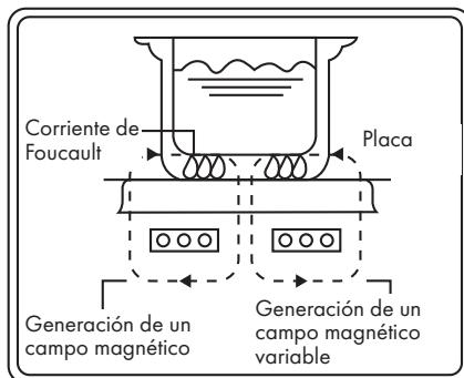
Cuando se conecta la fuente de alimentación al dispositivo, la corriente eléctrica genera un campo magnético en la bobina de inducción incrustada en el dispositivo. Tan pronto como las líneas del campo magnético tocan la olla de acero aleado, se crea el efecto de calentamiento, que llevaría a un calentamiento de la comida en la olla.
