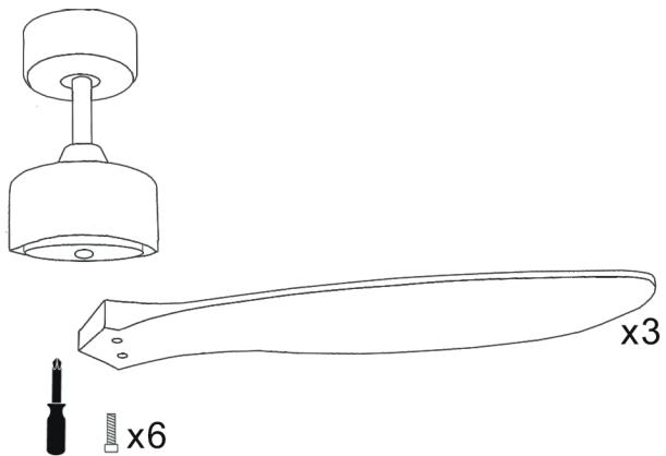
Fixez les pales du rotor avec 2 vis chacune. Le ventilateur est maintenant complètement assemblé et peut être utilisé.
