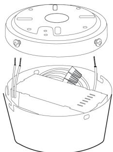
Stecken Sie den Empfänger und die Drähte in die obere Kappe.
