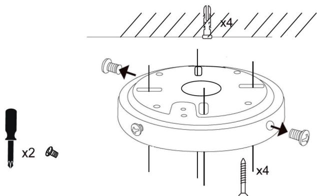
Befestigen Sie die Deckenplatte mit 4 Dübeln und Schrauben an der Decke.
