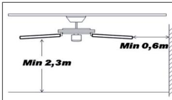
Der Mindestabstand zwischen den Ventilatorblättern und dem Boden muss mehr als 2,3 m betragen. Die Mindesttragfähigkeit des Hakens, an dem der Ventilator aufgehängt wird, muss 100 kg betragen.
