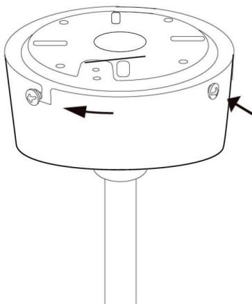
Befestigen Sie die obere Kappe und die Deckenplatte mit 4 Schrauben.
