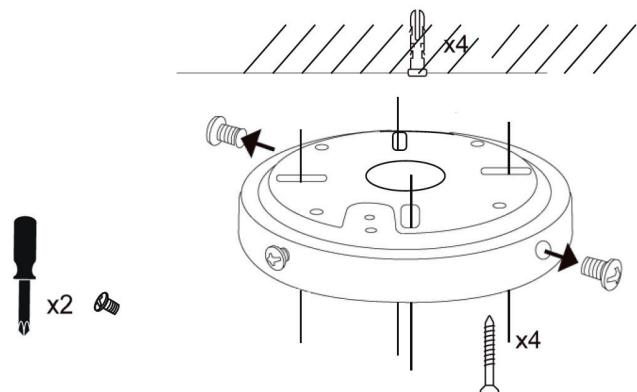
Fixez la platine de plafond au plafond avec 4 chevilles et vis.
