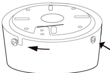
Fije la tapa superior y la placa para el techo con 4 tornillos.
