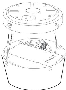
Conecte el receptor y los cables a la tapa superior.
