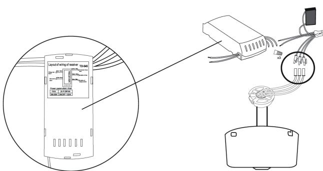
Connectez les fils du récepteur et du moteur.
