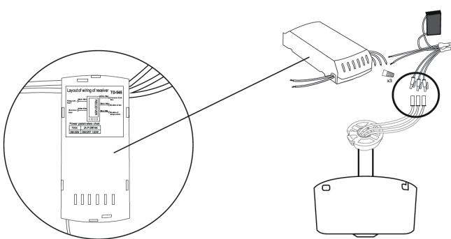
Verbinden Sie die Drähte von Empfänger und Motor.
