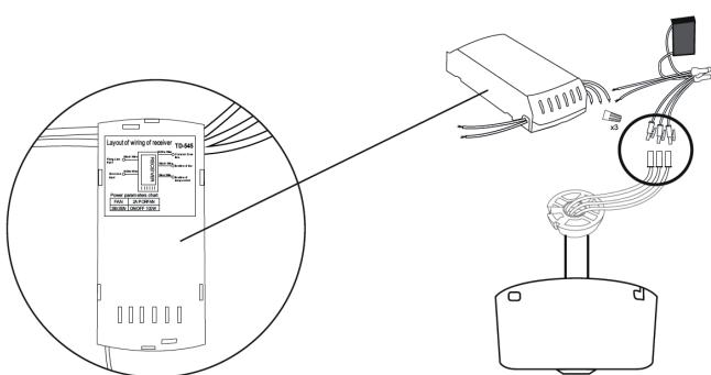
Collegare i fili del ricevitore e del motore.
