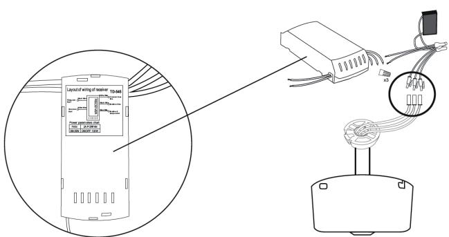
Conecte los cables del receptor y motor.
