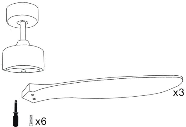
Befestigen Sie die Rotorblätter mit jeweils 2 Schrauben. Der Ventilator ist nun fertig zusammengebaut und kann benutzt werden.
