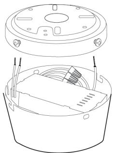
Inserire il ricevitore e i fili nel cappuccio superiore.
