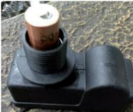
Öffnen Sie die Abdeckung des Zündknopfs und legen Sie eine Batterie des Typs AAA in das Batteriefach ein. Schließen Sie die Abdeckung anschließend wieder (siehe Abbildung 11).
